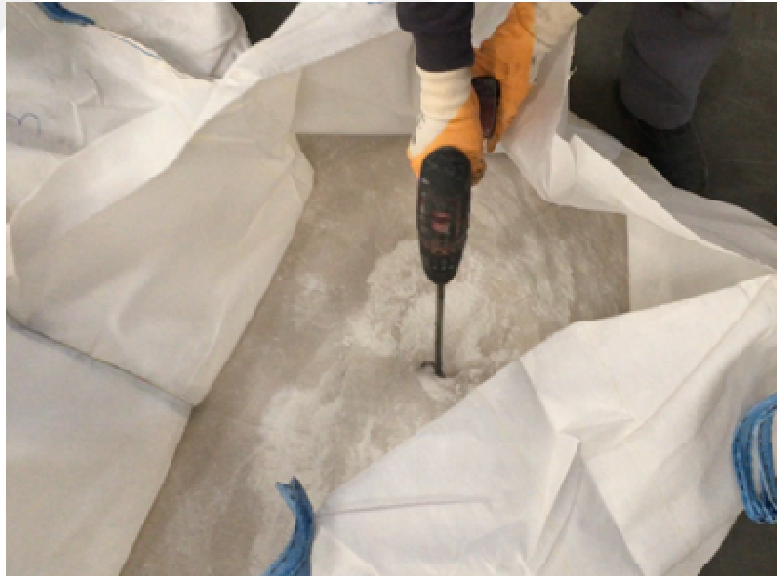
Şekil 2.3. Atık boru tozu ve kumun karıştırılması.
