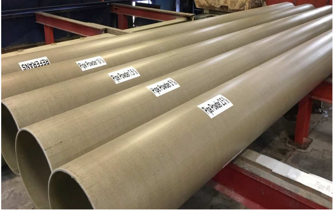
Şekil 2.6. Üretilmiş CTP kompozit borular.
