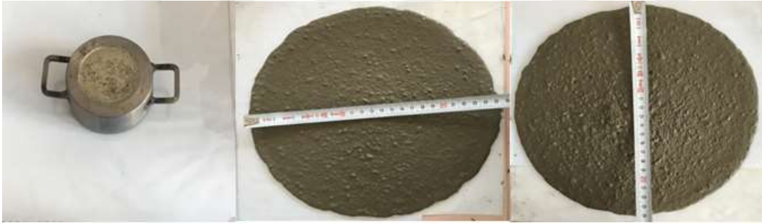
Şekil 4.4. Mini çökme yayılma konisi ve yayılma çapının ölçümü
