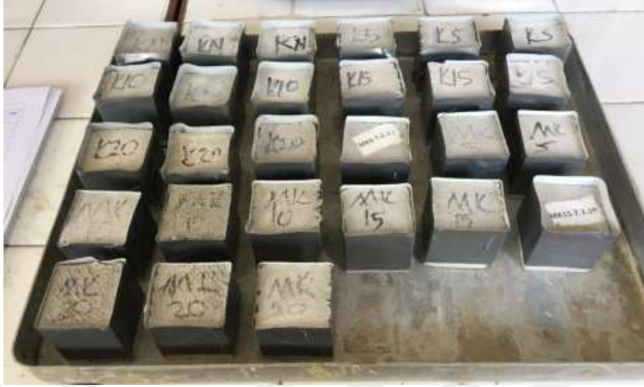
Şekil 4.13. Yan yüzeyleri izole edilen küp numuneleri
