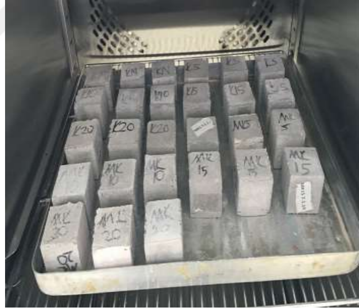
Şekil 4.12. Etüvde kurutulmuş numuneler
