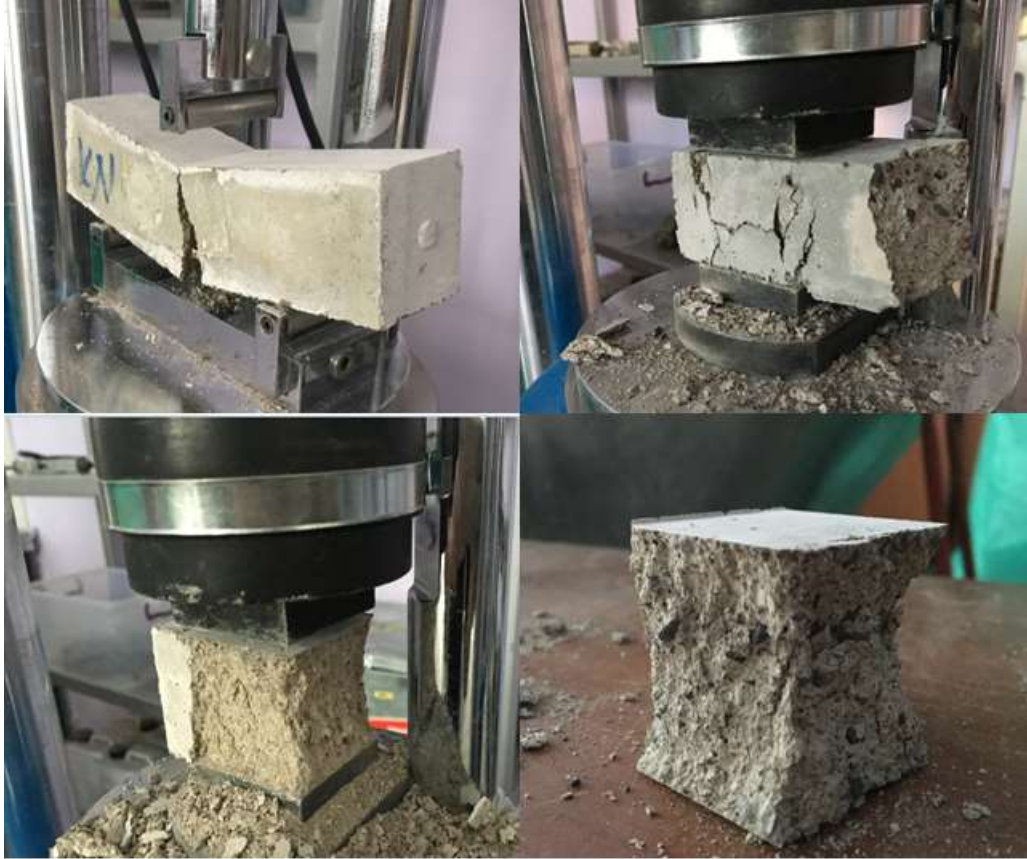
Şekil 4.18. Yüksek sıcaklığa maruz kalan numunelerin eğilme ve basınç deneyi
