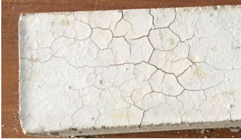
Şekil 4.17. Sıcaklığa maruz bırakılan numunede rötre çatlakları
