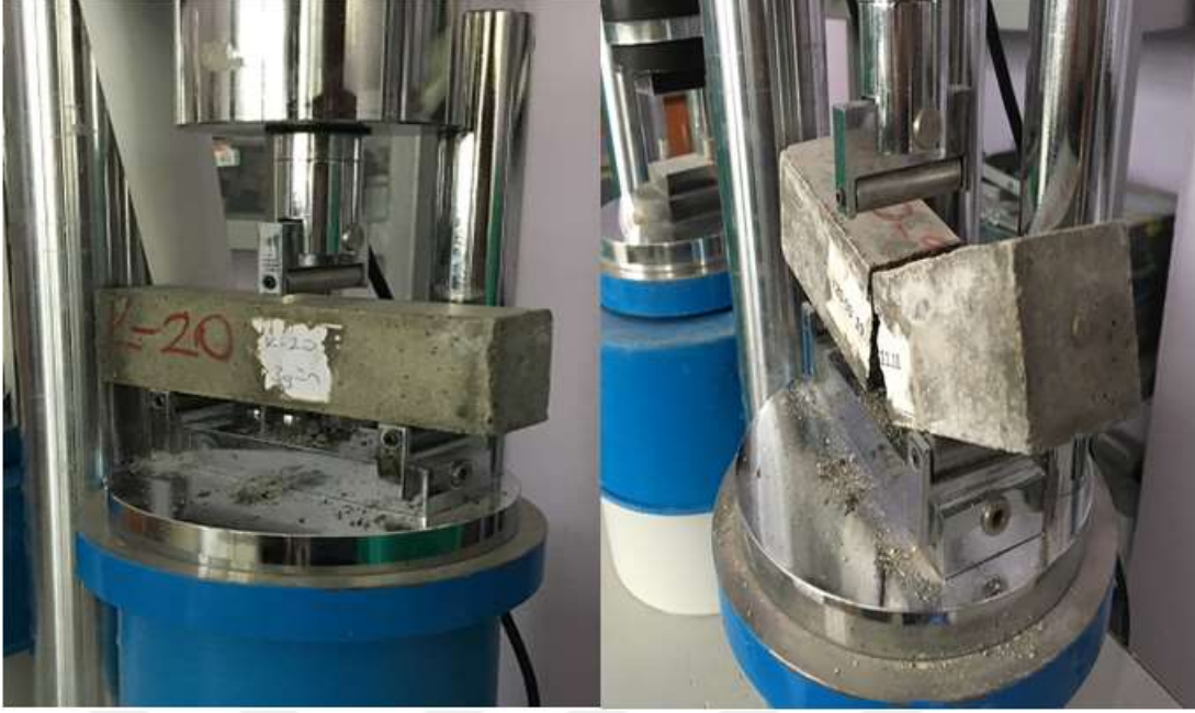
Şekil 4.8. Üç noktalı eğilme deneyi
