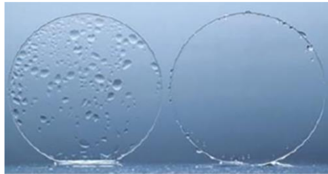
Şekil 2.6. Hidrofobik film kaplı cam yüzeyle, kaplı olmayan cam yüzeyin ıslanma durumu [20].
