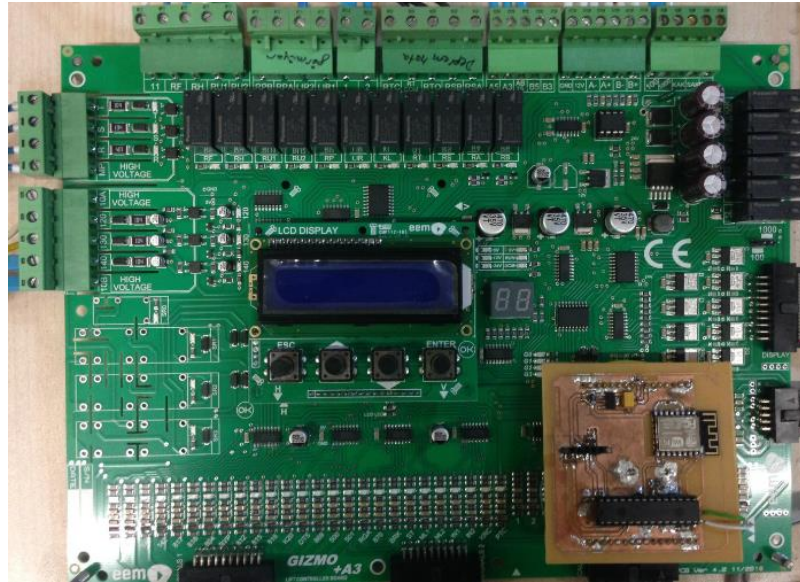
Şekil 3.12. Dönüştürücü Kartının Asansör Kontrol Kartı Üzerine Adapte Edilmiş Hali
