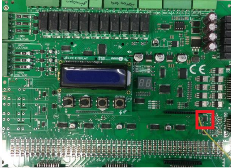
Şekil 3.13. Asansör Kontrol Kartı Üzerinde Bulunan RS485 Entegresi
