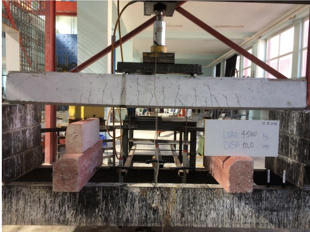
Şekil 4.98. NOR-C60-Etsz deney elemanının akma anındaki durumu
