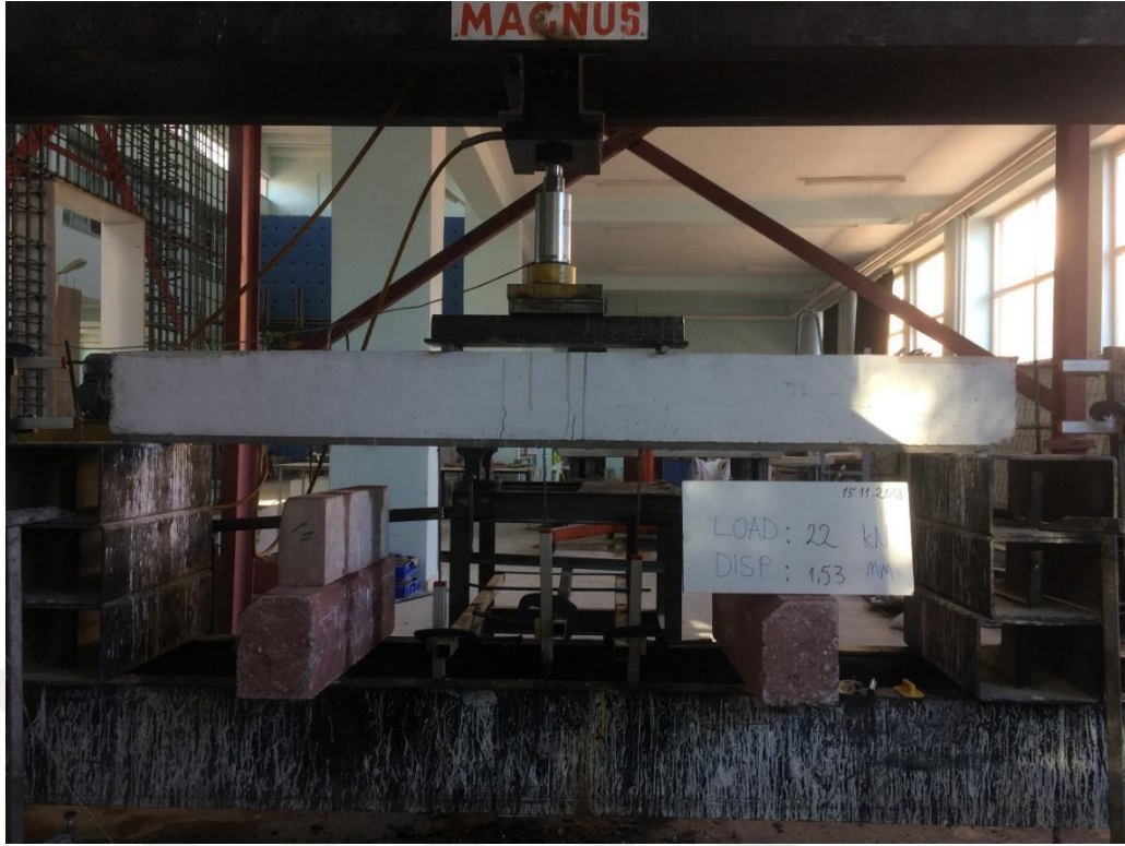
Şekil 4.39. NOR-C30-5 elemanında oluşan ilk çatlaklar
