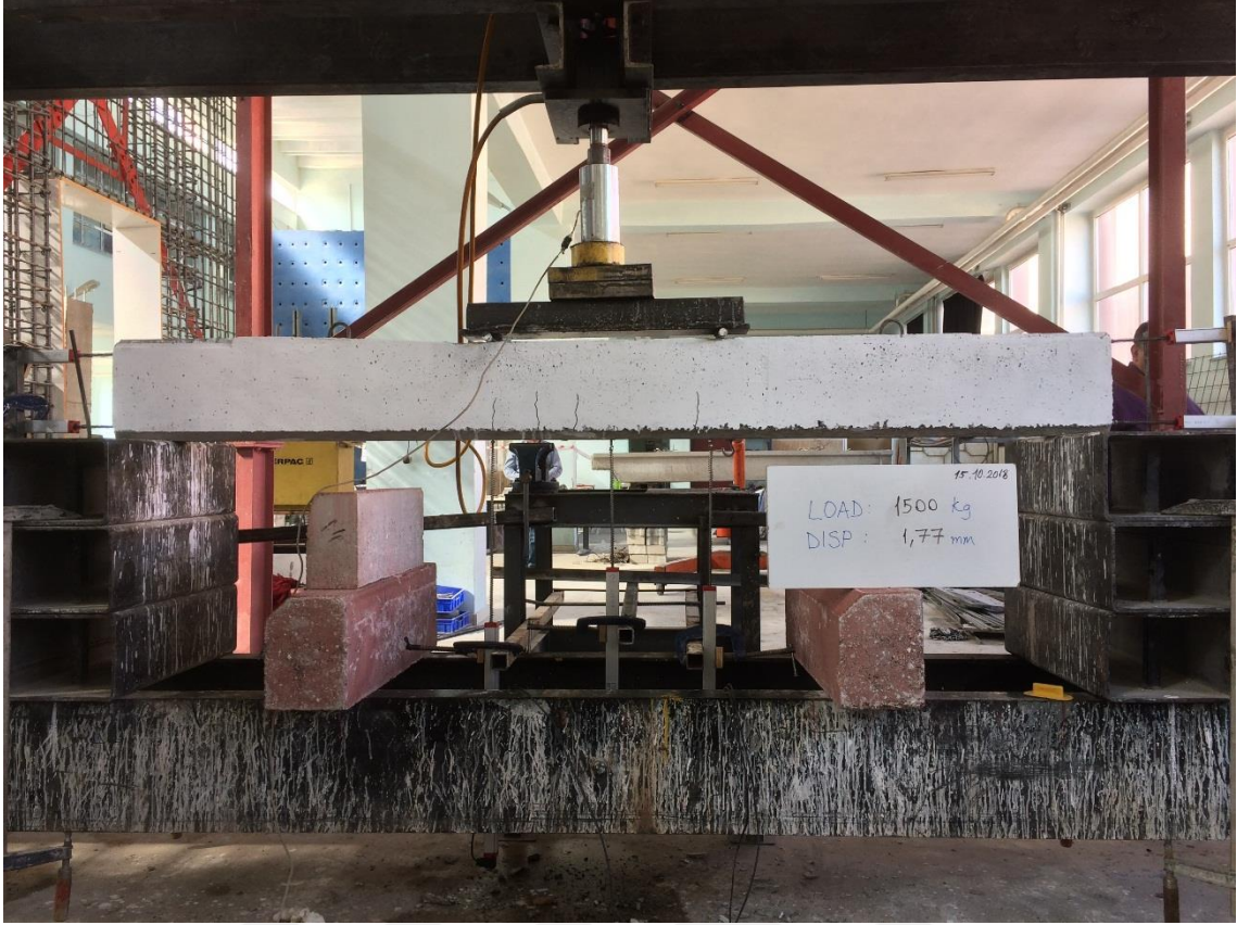
Şekil 4.14. NOR-C30-20 elemanın oluşan ilk çatlaklar
