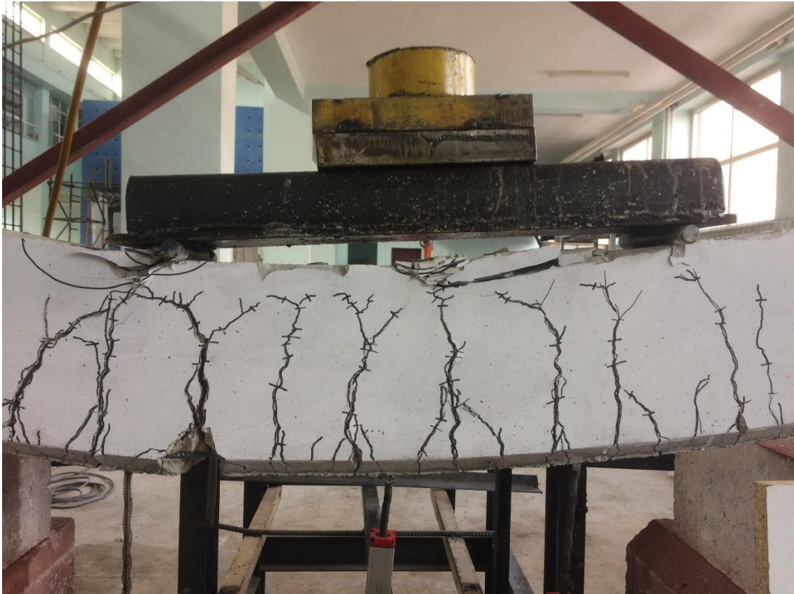
Şekil 4.18. NOR-C30-20 deney elemanın deney sonundaki çatlak dağılımı
