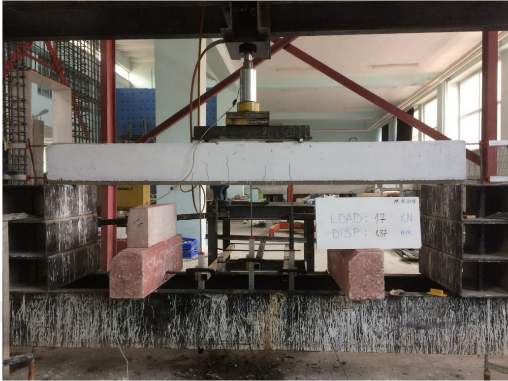
Şekil 4.143. KYB-C60-Etsz elemanın oluşan ilk çatlaklar
