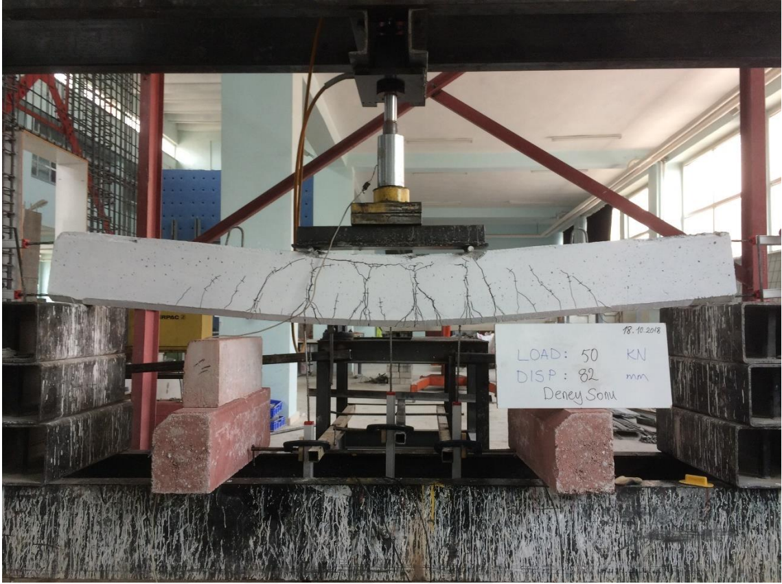
Şekil 4.111. KYB-C60-20 deney elemanın deney sonundaki durumu
