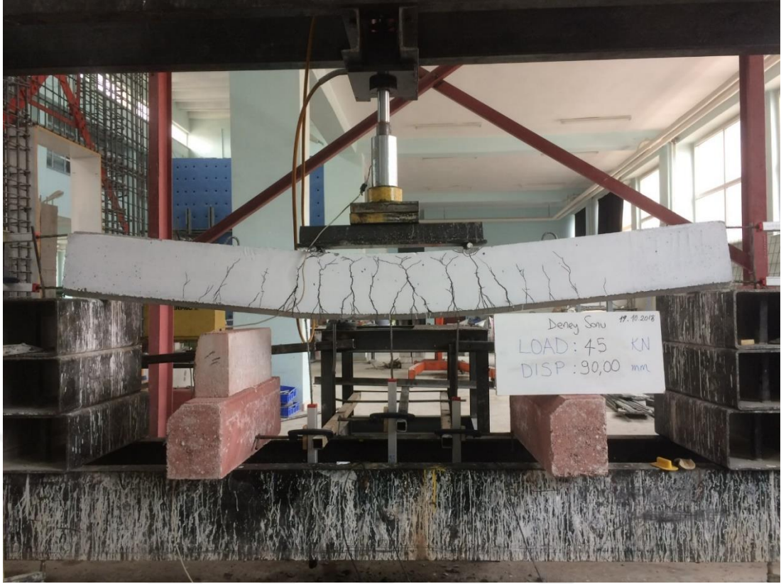
Şekil 4.146. KYB-C60-Etsz deney elemanının deney sonundaki durumu
