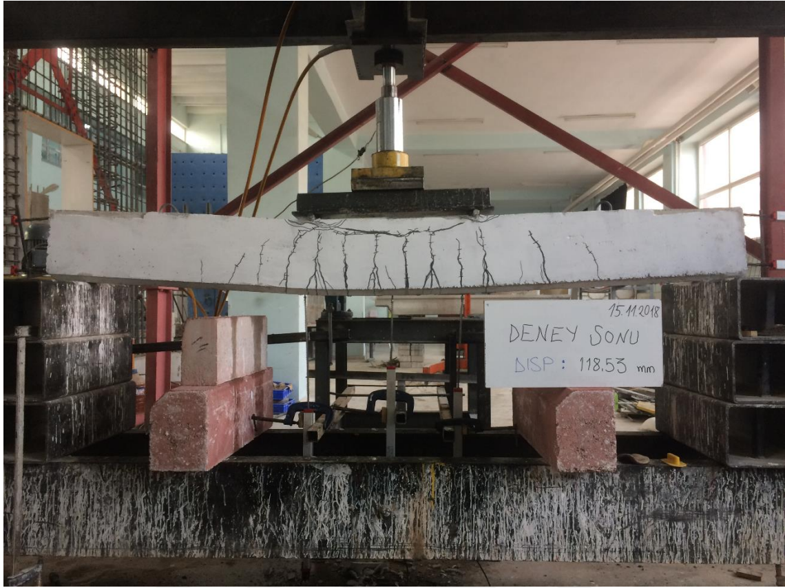
Şekil 4.66. KYB-C30-20 deney elemanının deney sonundaki durumu
