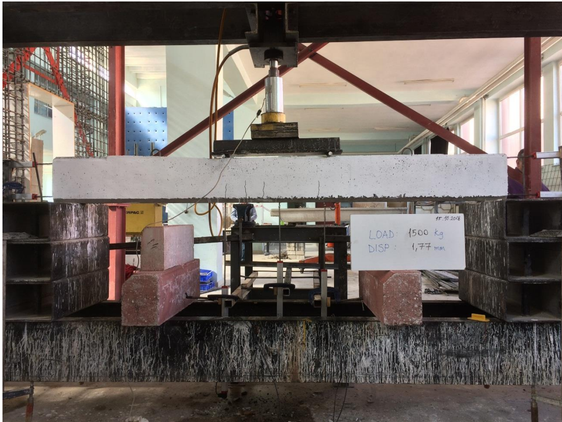
Şekil 4.167. KYB-C60-10 elemanın oluşan ilk çatlaklar
