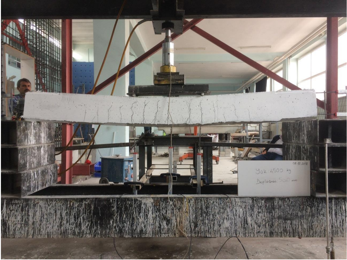
Şekil 4.122. NOR-C60-10 deney elemanının maksimum yük anındaki durumu
