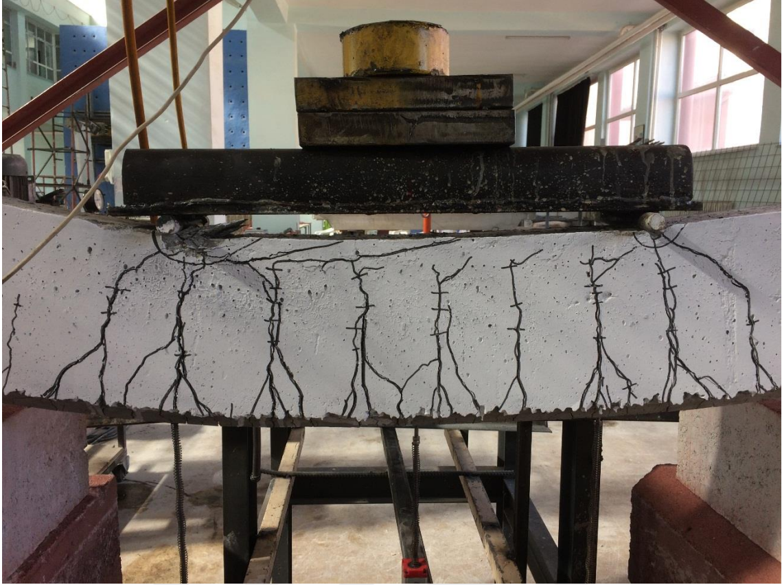
Şekil 4.171. KYB-C60-10 deney elemanının deney sonundaki çatlak dağılımı
