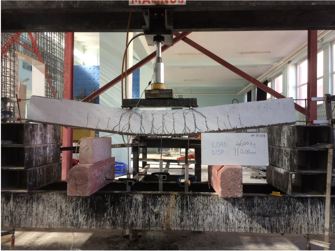
Şekil 4.169. KYB-C60-10 deney elemanının maksimum yük anındaki durumu
