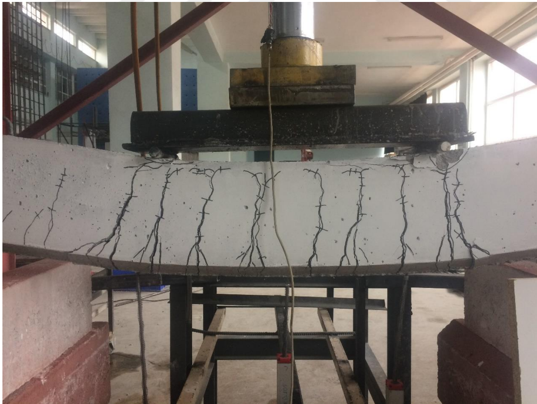
Şekil 4.159. KYB-C60-20 deney elemanın deney sonundaki çatlak dağılımı
