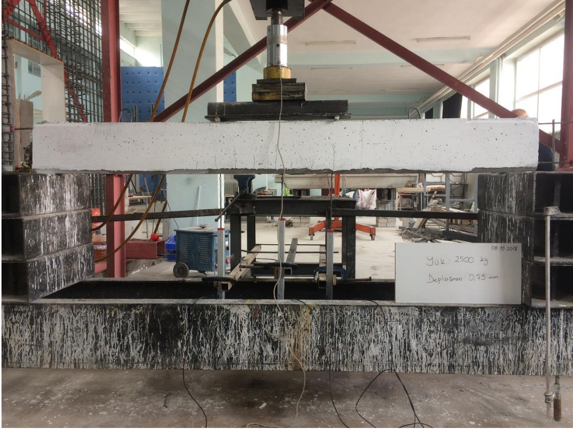
Şekil 4.120. NOR-C60-10 elemanın oluşan ilk çatlaklar
