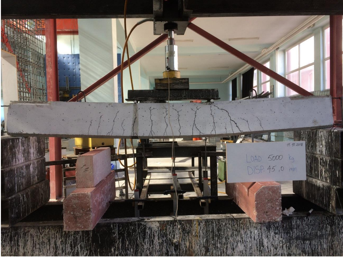
Şekil 4.99. NOR-C60-Etsz deney elemanının maksimum yük anındaki durumu
