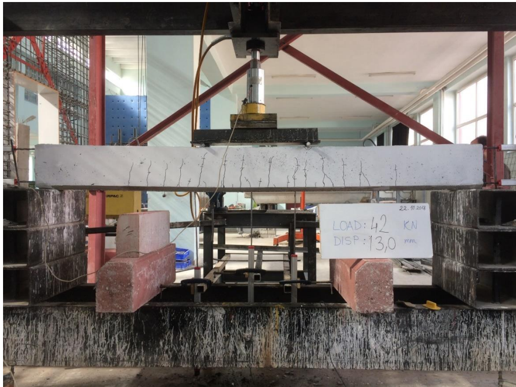
Şekil 4.180. KYB-C60-5 deney elemanının akma anındaki durumu
