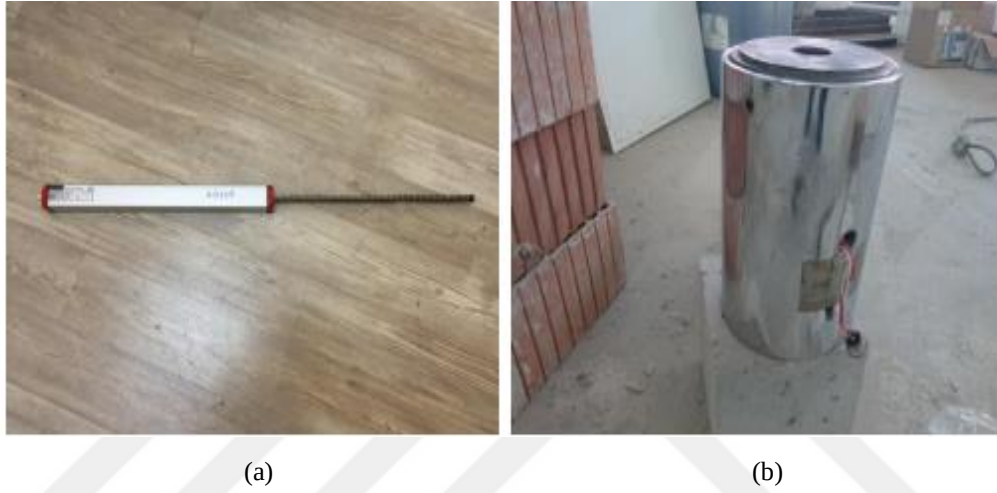
Şekil 3.11. Deneylerde kullanılan: a) potansiyometrik cetvel, b) yük hücresi
