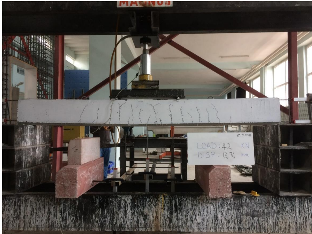
Şekil 4.144. KYB-C60-Etsz deney elemanın akma anındaki durumu
