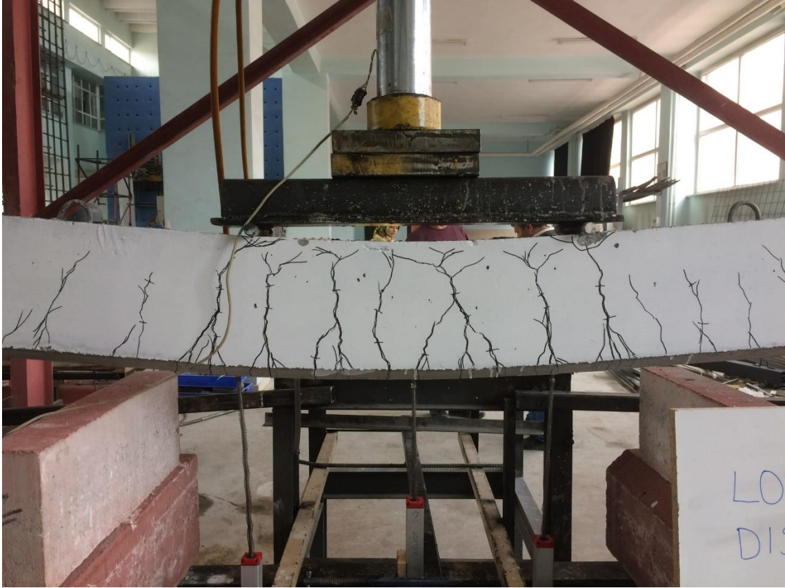
Şekil 4.145. KYB-C60-Etsz deney elemanının maksimum yük anındaki durumu
