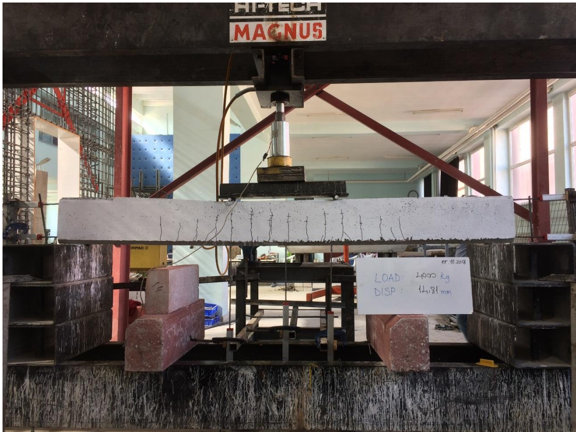
Şekil 4.168. KYB-C60-10 deney elemanının akma anındaki durumu
