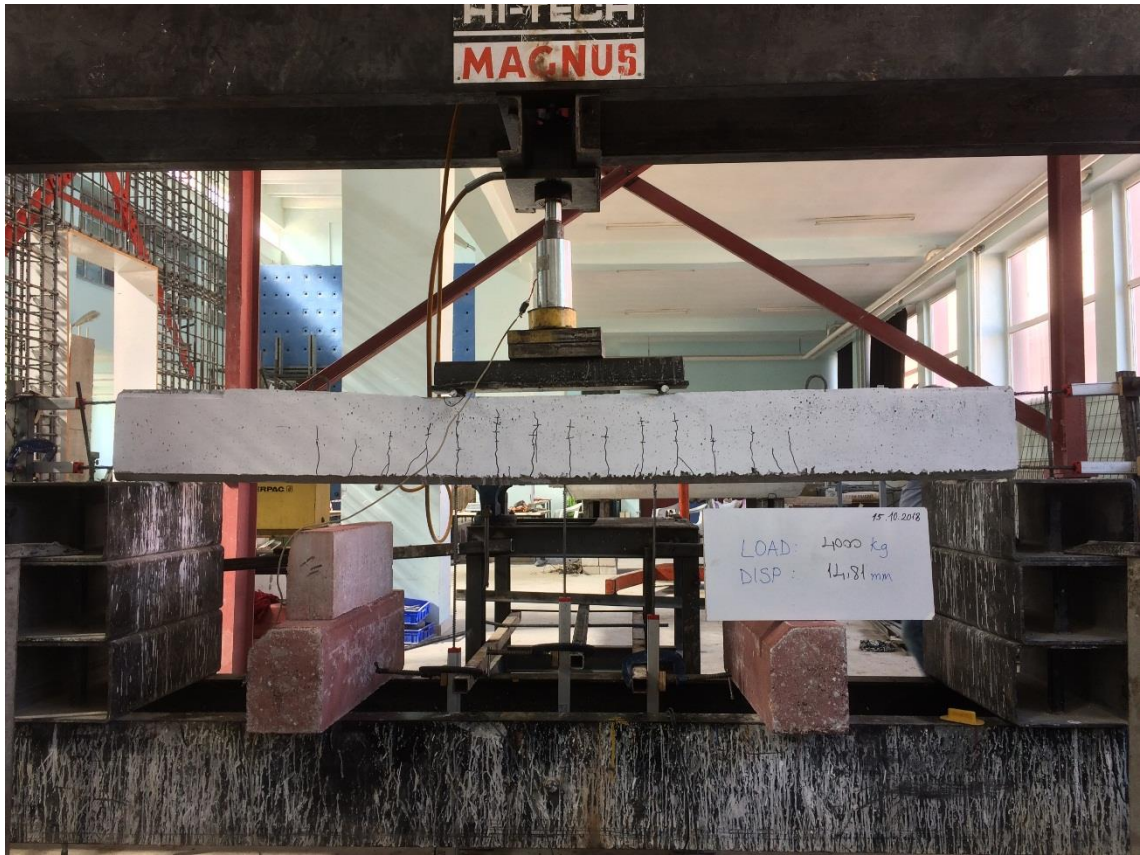
Şekil 4.15. KYB-C60-10 deney elemanının akma anındaki durumu
