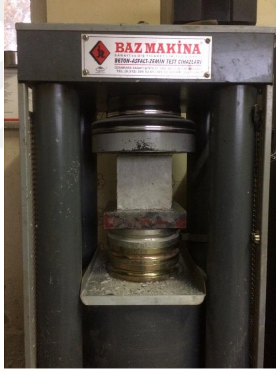
Şekil 3.10. Beton basınç deneyi aleti
