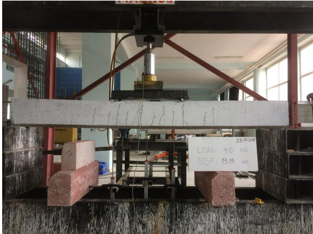
Şekil 4.156. KYB-C60-20 deney elemanının akma anındaki durumu
