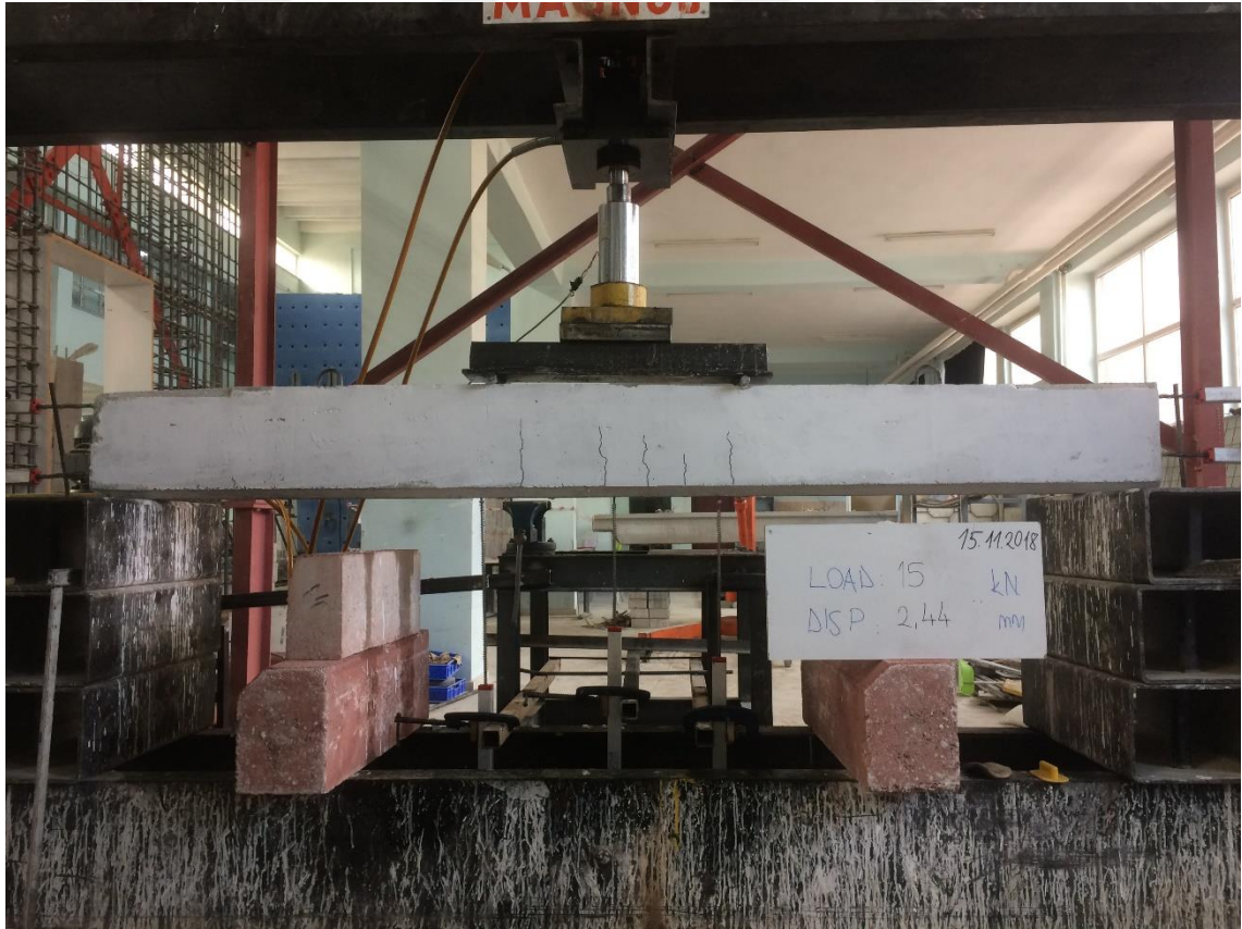
Şekil 4.74. KYB-C30-10 elemanın oluşan ilk çatlaklar
