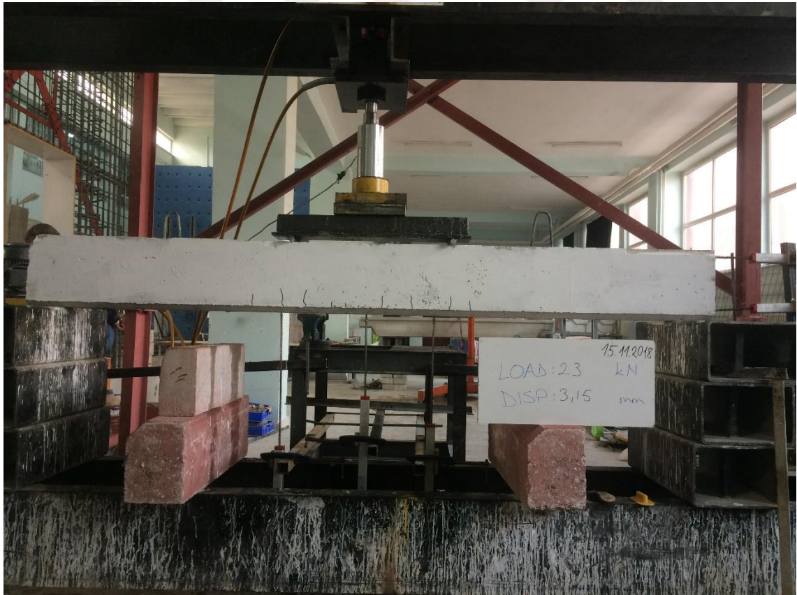
Şekil 4.27. NOR-C30-10 elemanın oluşan ilk çatlaklar
