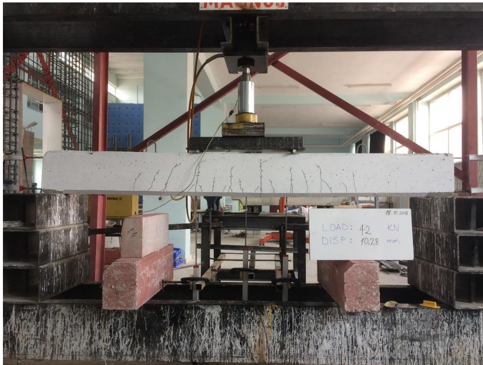
Şekil 4.109. KYB-C60-20 deney elemanının akma anındaki durumu
