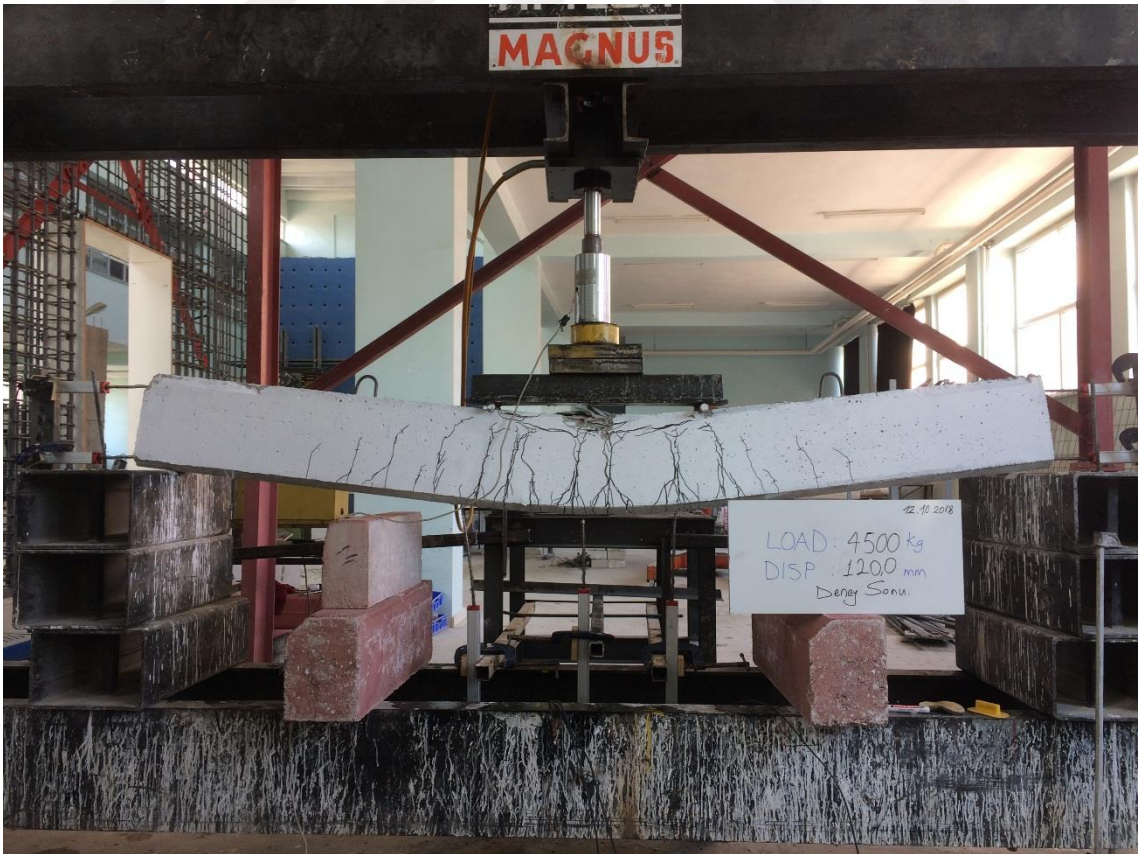
Şekil 4.135. NOR-C60-5 deney elemanının deney sonundaki durumu
