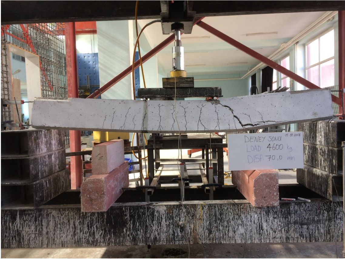
Şekil 4.100. NOR-C60-Etsz deney elemanının deney sonundaki durumu
