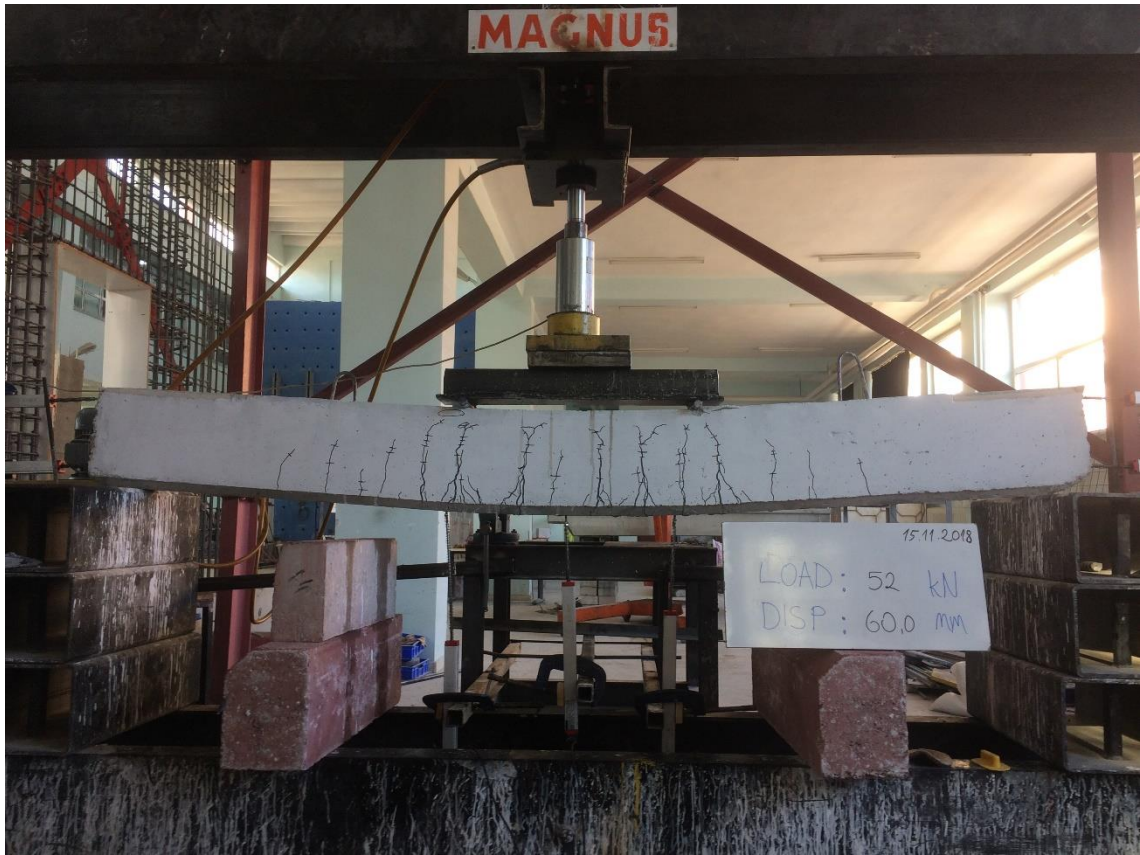
Şekil 4.41. NOR-C30-5 deney elemanının maksimum yük anındaki durumu
