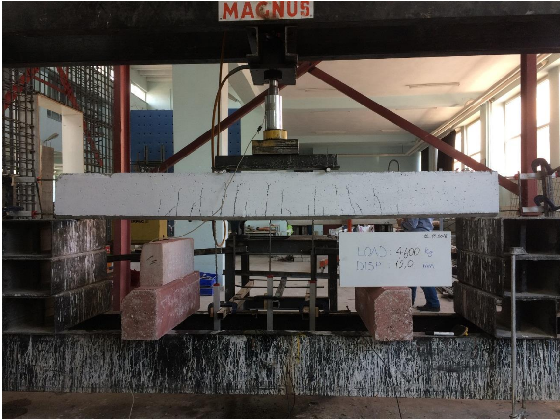
Şekil 4.133. NOR-C60-5 deney elemanın akma anındaki durumu
