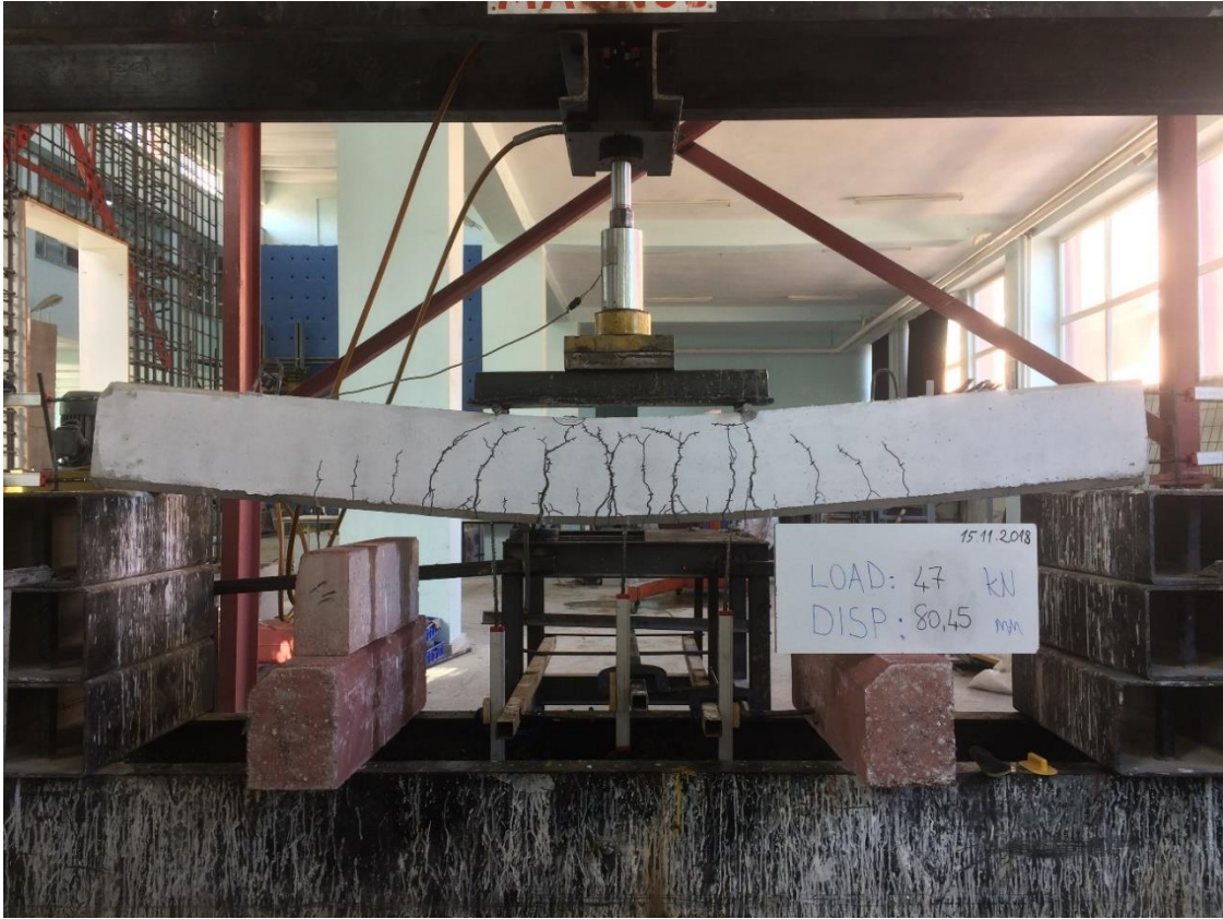
Şekil 4.4. NOR-C30-Etsz deney elemanının maksimum yük anındaki durumu
