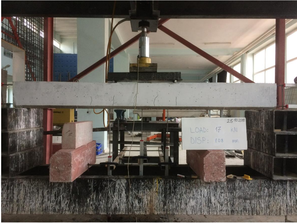
Şekil 4.155. KYB-C60-20 elemanın oluşan ilk çatlaklar
