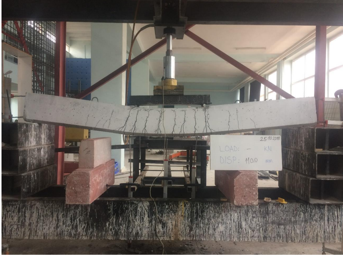
Şekil 4.157. KYB-C60-20 deney elemanının maksimum yük anındaki durumu
