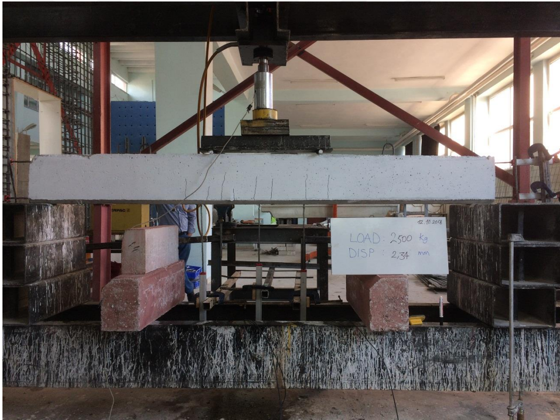
Şekil 4.132. NOR-C60-5 elemanın oluşan ilk çatlaklar
