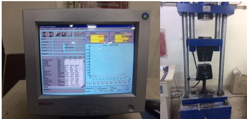
Şekil 3.9. Donatıların mekanik özelliklerinin belirlenmesi
