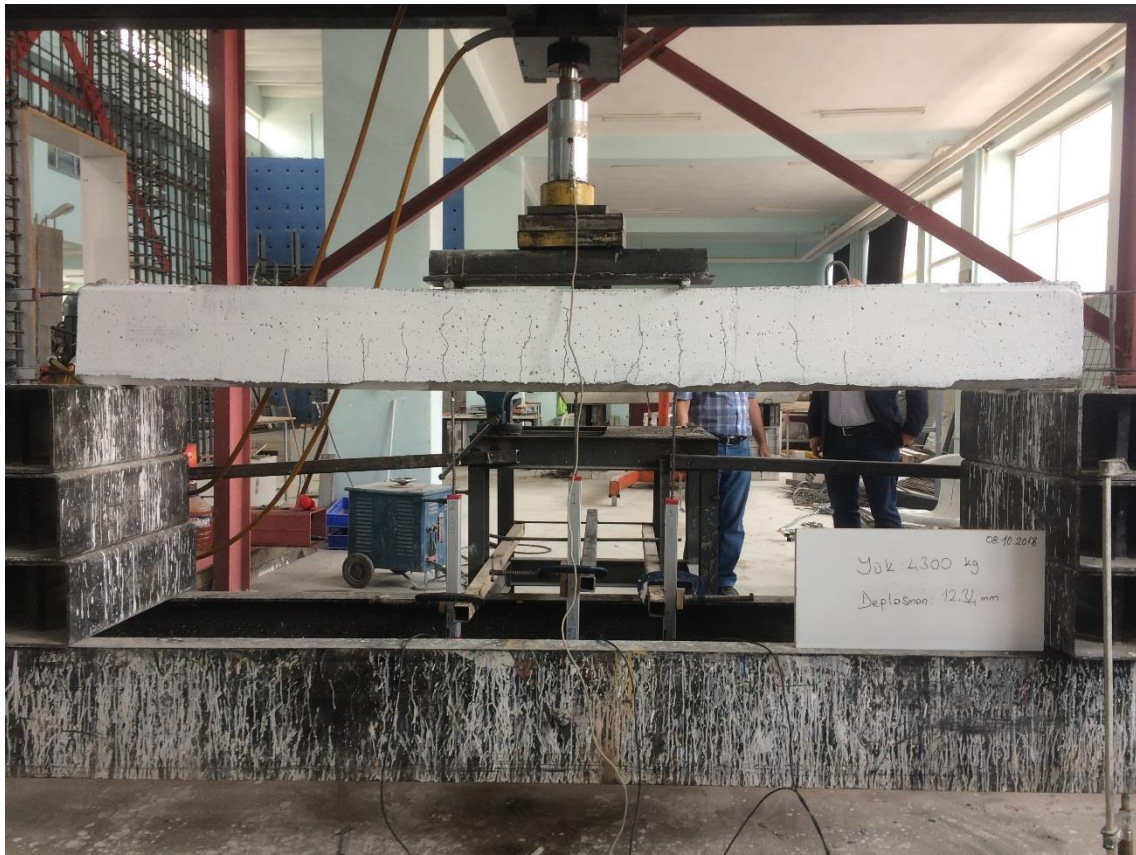
Şekil 4.121. NOR-C60-10 deney elemanının akma anındaki durumu
