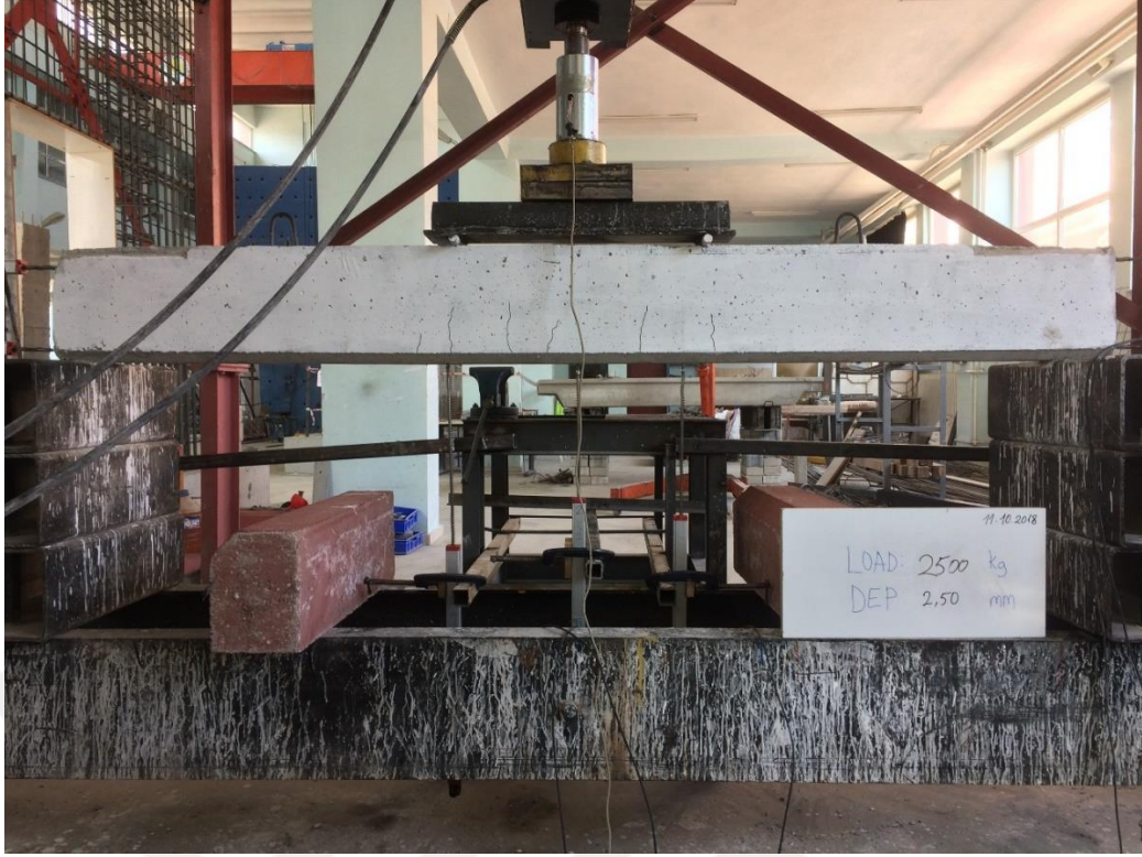
Şekil 4.97. NOR-C60-Etsz elemanın oluşan ilk çatlaklar
