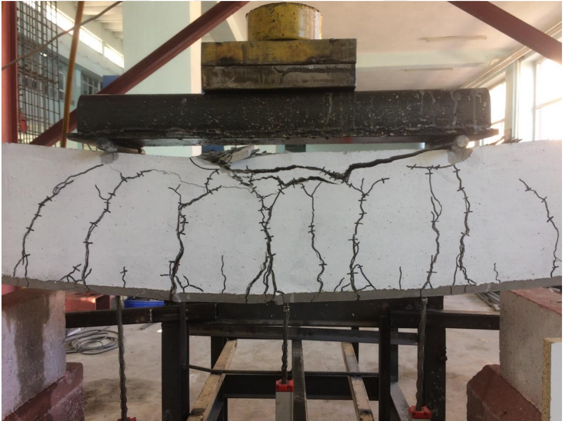
Şekil 4.6. NOR-C30-Etsz deney elemanının deney sonundaki çatlak dağılımı
