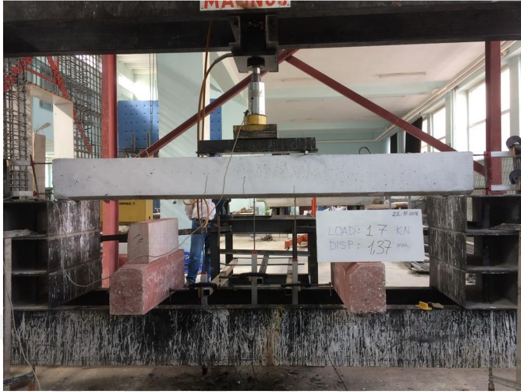
Şekil 4.179. KYB-C60-5 elemanın oluşturan ilk çatlaklar
