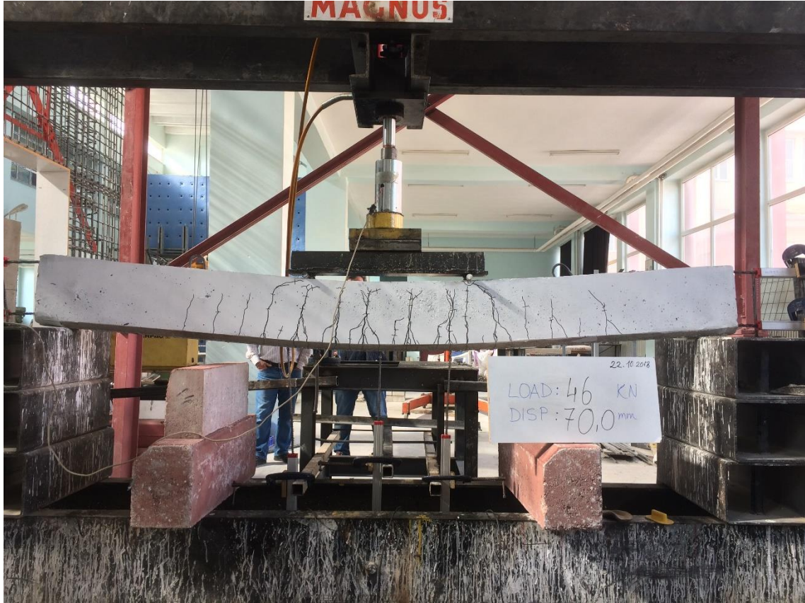
Şekil 4.181. KYB-C60-5 deney elemanının maksimum yük anındaki durumu
