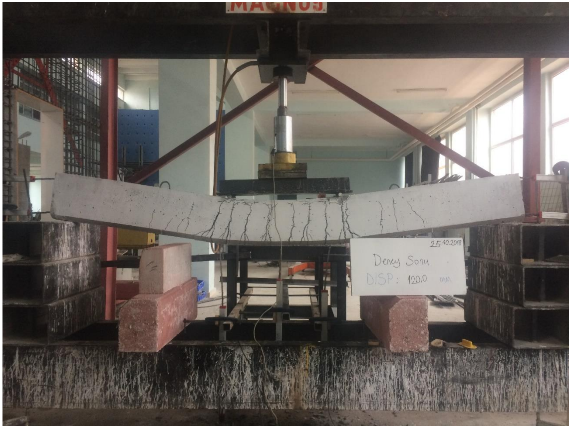
Şekil 4.158. KYB-C60-20 deney elemanın deney sonundaki durumu
