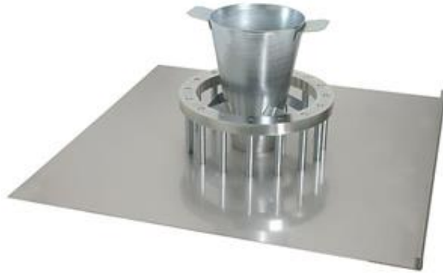
Şekil 1.6. J-halkası deneyinin yapıldığı aparat (Anonim, 2018c)
