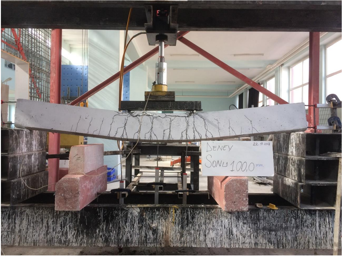
Şekil 4.88. KYB-C30-5 deney elemanının deney sonundaki durumu
