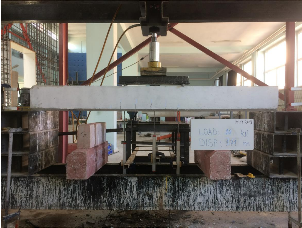
Şekil 4.2. NOR-C30-Etsz elemanın oluşan ilk çatlaklar
