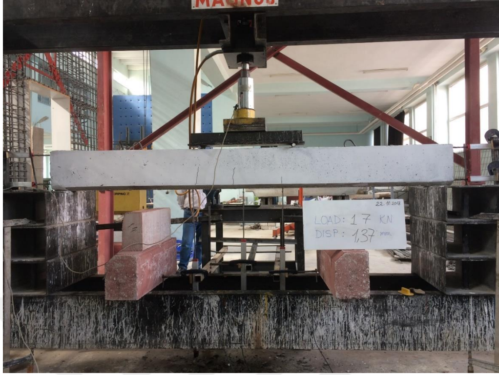
Şekil 4.85. KYB-C30-5 elemanın oluşan ilk çatlaklar
