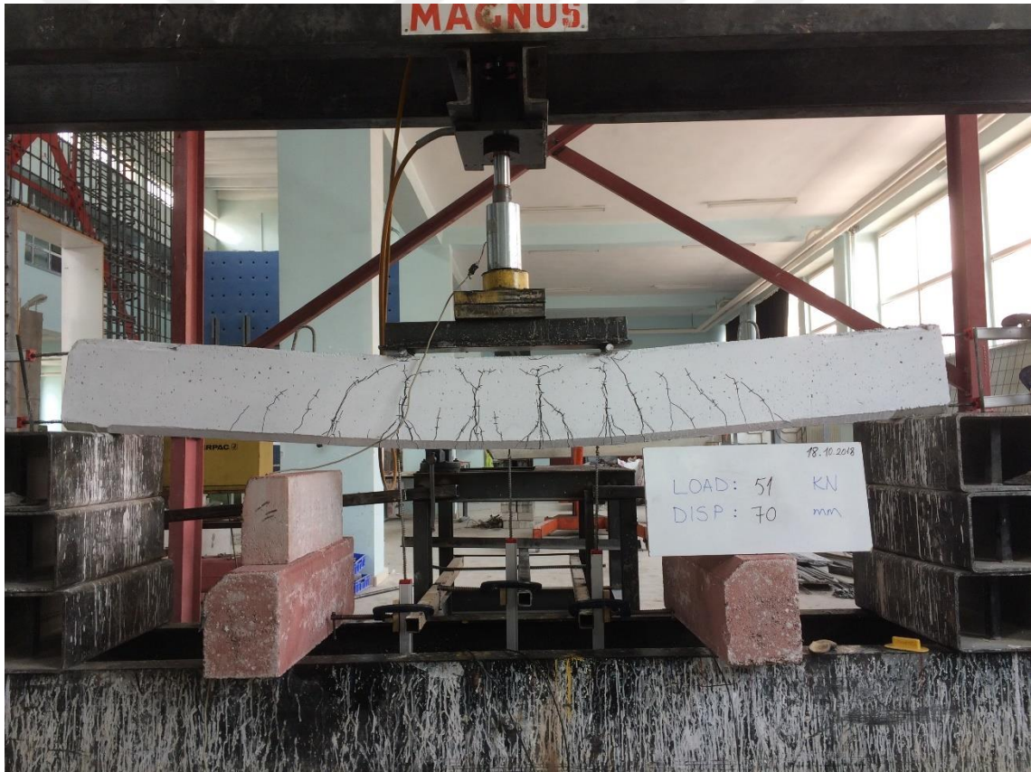
Şekil 4.110. KYB-C60-20 deney elemanının maksimum yük anındaki durumu
