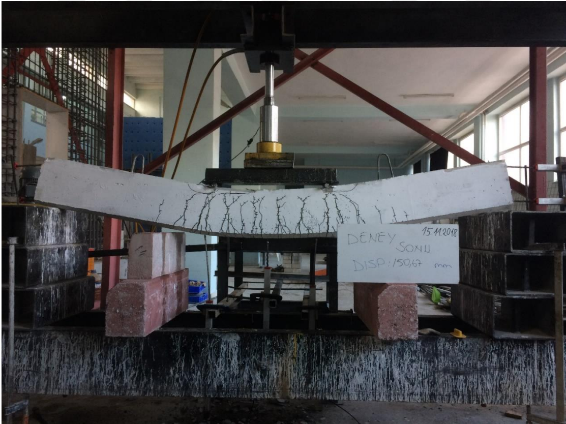
Şekil 4.30. NOR-C30-10 deney elemanının deney sonundaki durumu
