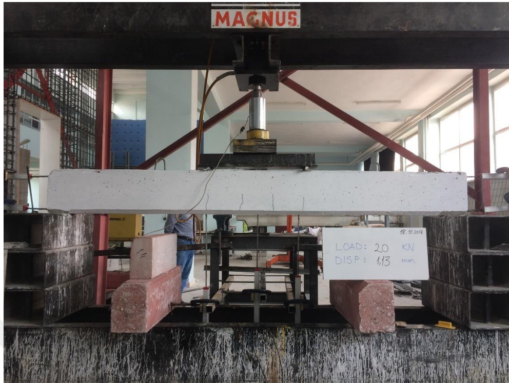
Şekil 4.108. KYB-C60-20 elemanın oluşan ilk çatlaklar
