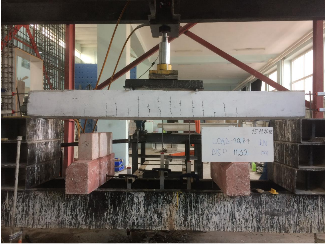
Şekil 4.75. KYB-C30-10 deney elemanının akma anındaki durumu
