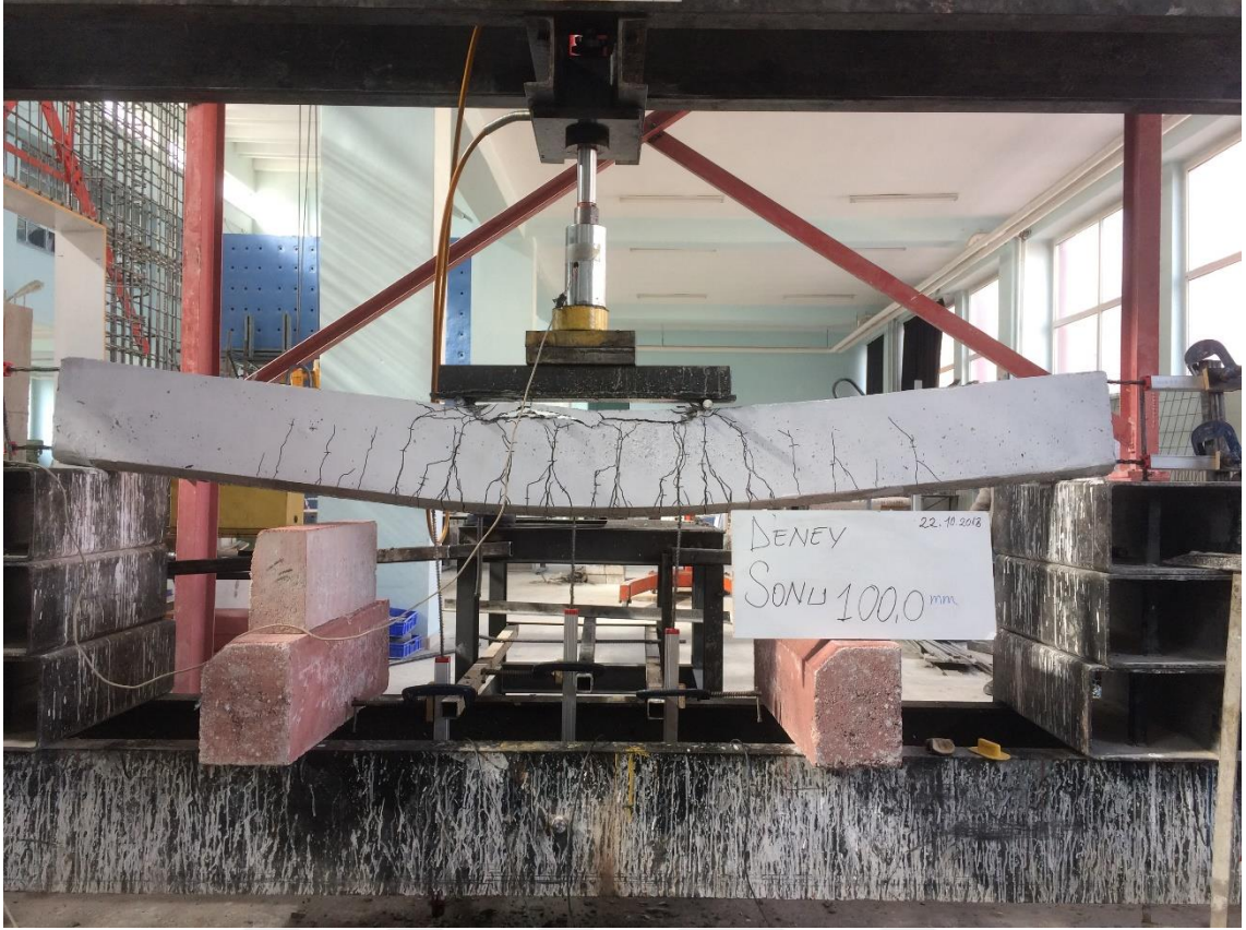
Şekil 4.182. KYB-C60-5 deney elemanın deney sonundaki durumu
