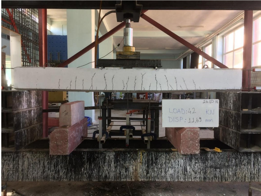
Şekil 4.52. KYB-C30-Etsz deney elemanın akma anındaki durumu
