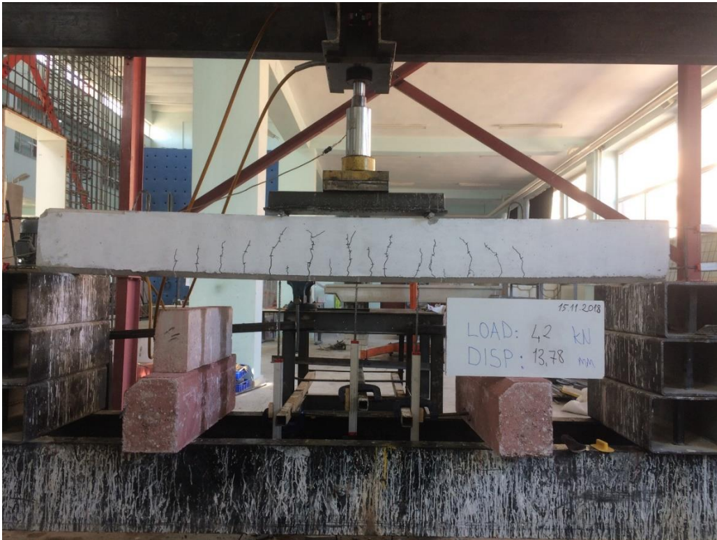
Şekil 4.3. NOR-C30-Etsz deney elemanın akma anındaki durumu
