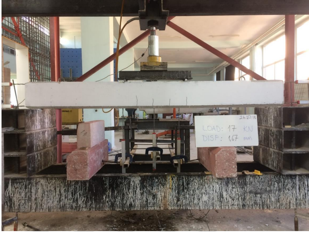
Şekil 4.51. KYB-C30-Etsz elemanın oluşan ilk çatlaklar
