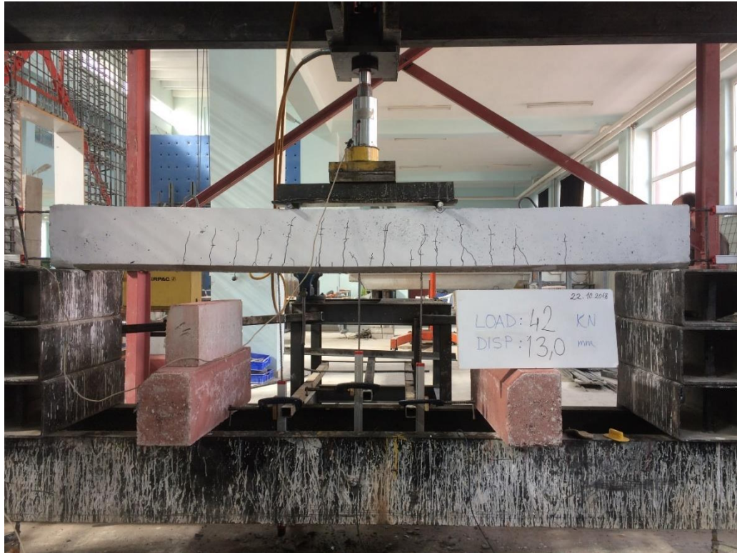
Şekil 4.86. KYB-C30-5 deney elemanının akma anındaki durumu
