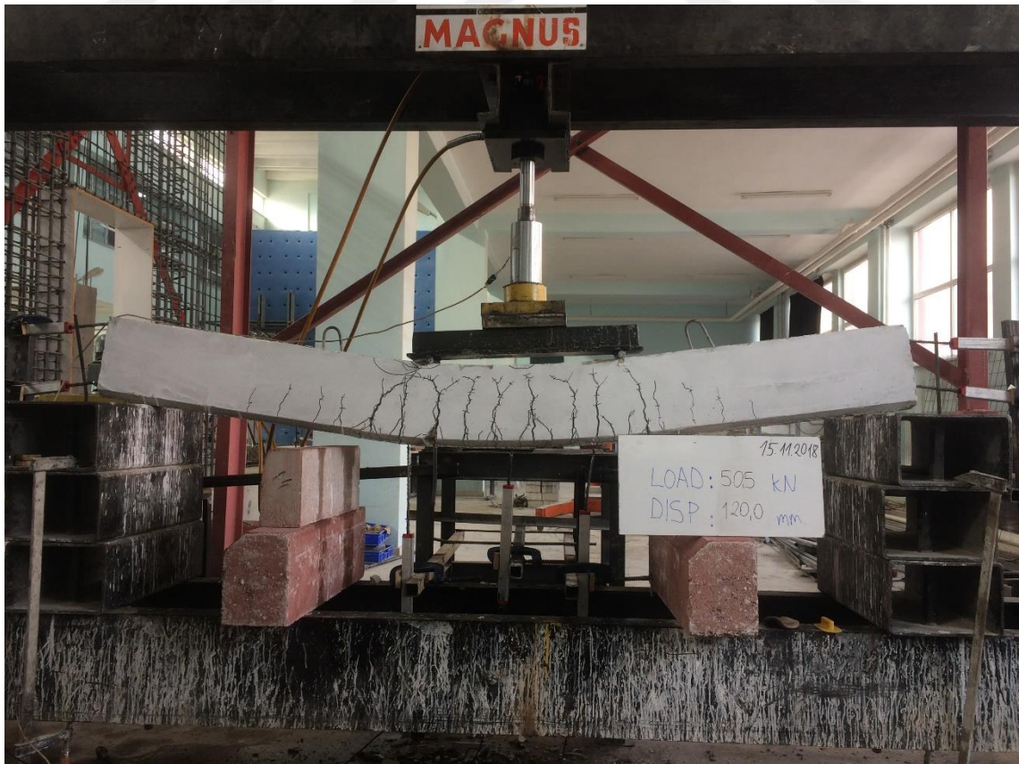
Şekil 4.16. NOR-C30-20 deney elemanının maksimum yük anındaki durumu
