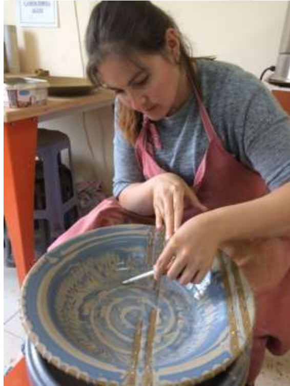
Fotoğraf 70: Deri sertliğindeki astarlı ürünün akıtma dekorunun uygulanması (Saadet MEKE 2019)
