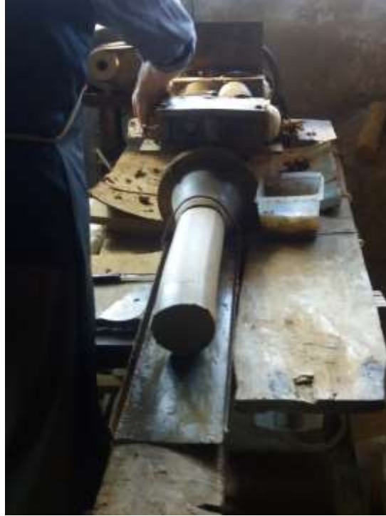
Fotoğraf 3: İçerisinden Çamur Geçirilen İki Silindirli Makine (Saadet MEKE 2018)
