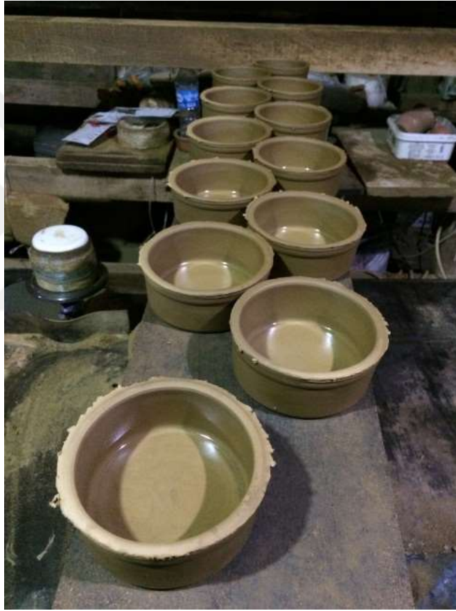
Fotoğraf 43 : Pres Kalıp ile Yapılan Sütlaçlık Güveçler.( Saadet MEKE 2017)
