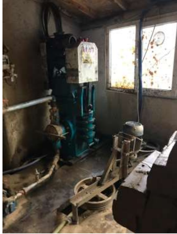
Fotoğraf 34 : Pervaneli Karıştırıcı ve Filterpres'e Basma Makinası (Saadet MEKE 2018)
