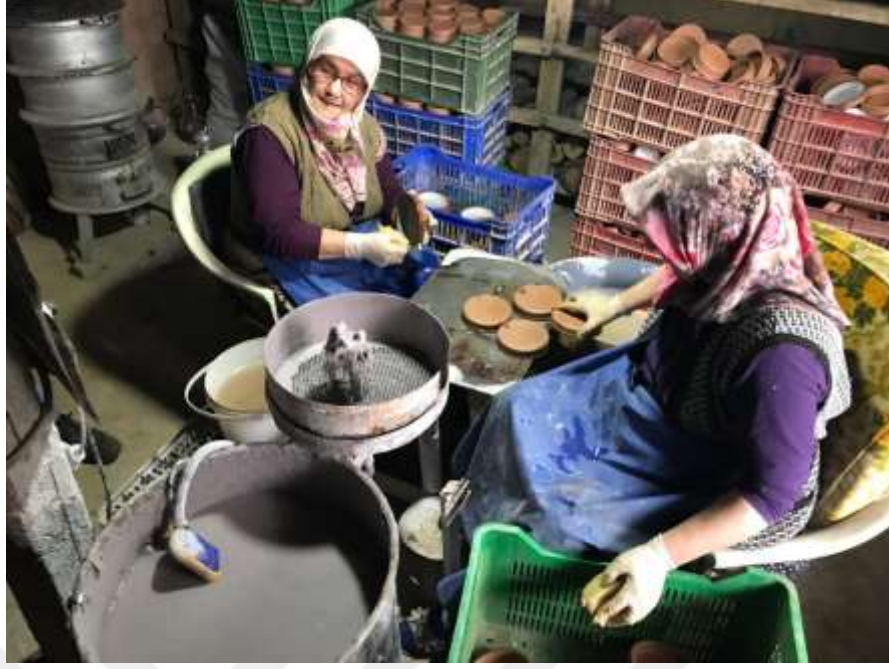
Fotoğraf 44 : Sütlaçlık Güveçlerin Sırlama aşaması. (Saadet MEKE 2018)
