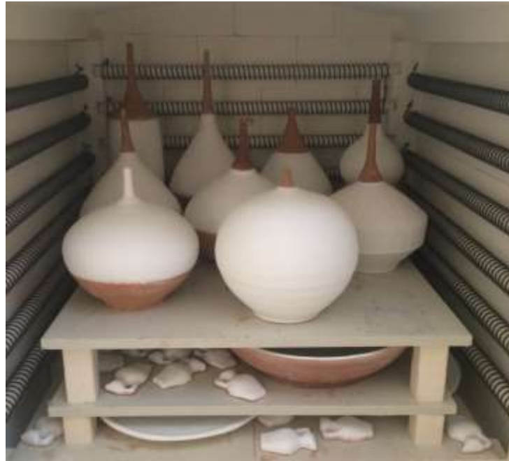
Fotoğraf 75: Sırlanmış ürünlerin fırına yerleştirilmesi (Saadet MEKE 2019)
