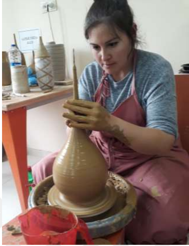
Fotoğraf 61: Çömlekçi çarkında şekillendirme aşaması (Saadet MEKE 2019)
