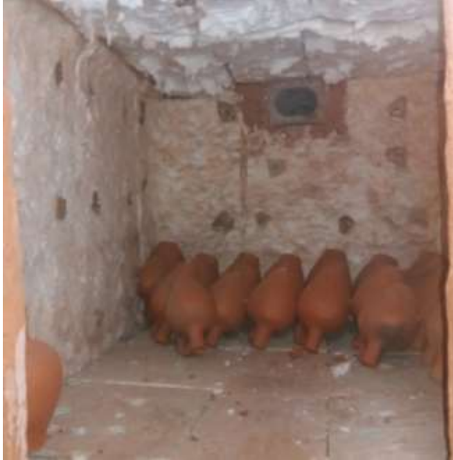
Fotoğraf 28 : Odunlu Fırın İçerisine Ürün Yerleştirilmesi. (Saadet MEKE 2017)
