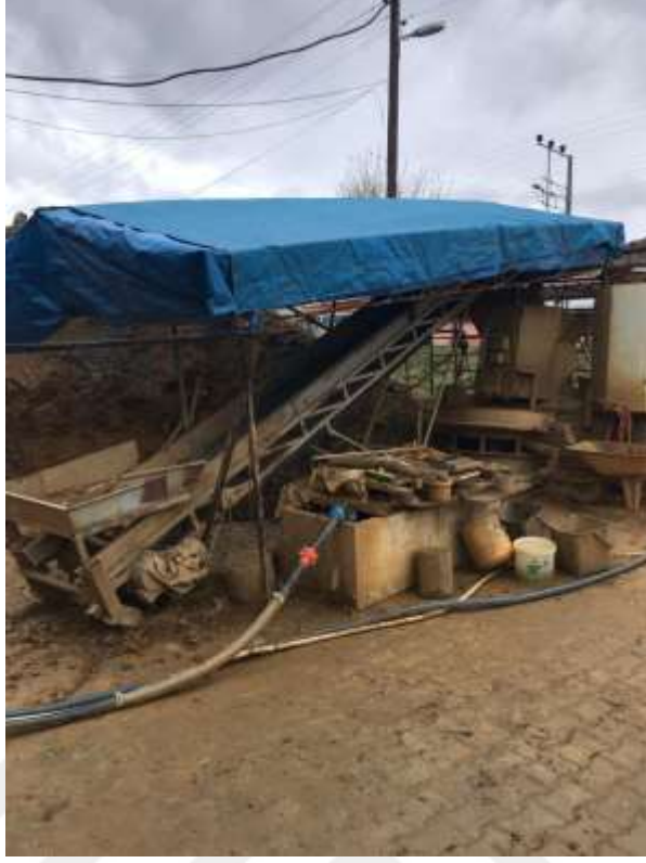
Fotoğraf 33 : Kırıık Toprağının Titreşimli Elekten Geçirilmesi ve borular ile havuzlara taşınması. (Saadet MEKE 2018)
