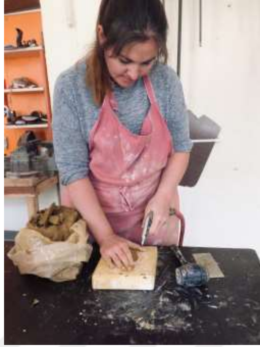
Fotoğraf 66: Renkli astar denemesi için deneme plakalarının yapım aşaması (Saadet MEKE 2019)
