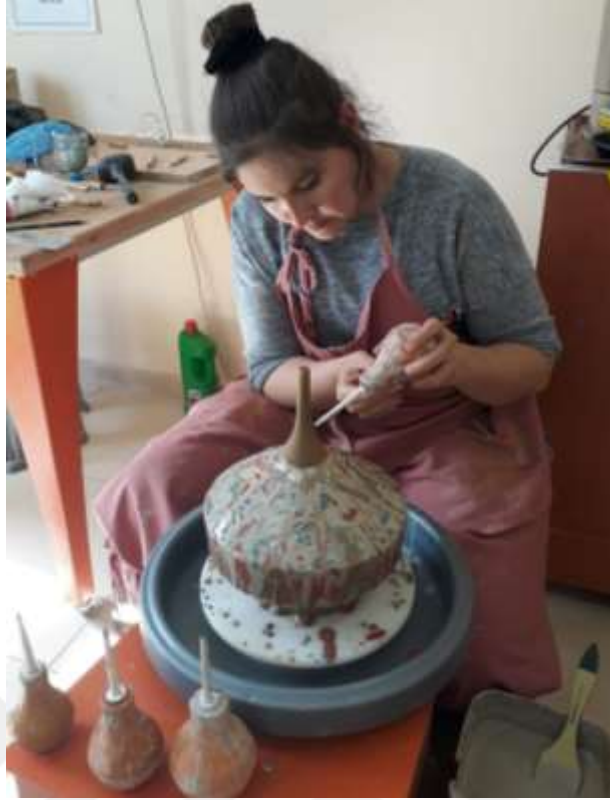
Fotoğraf 69: Deri sertliğindeki astarlı ürünün akıtma dekorunun uygulanması (Saadet MEKE 2019)
