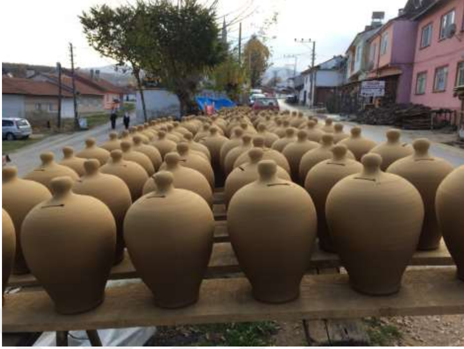
Fotoğraf 42 : Şekillendirilmesi Yapılan Kumbaraların Kuruma Aşaması.(Saadet MEKE 2017)
