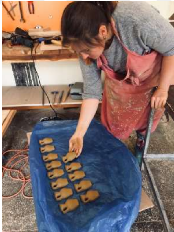
Fotoğraf 67: Renkli astar denemesi için deneme plakalarının yapım aşaması (Saadet MEKE 2019)
