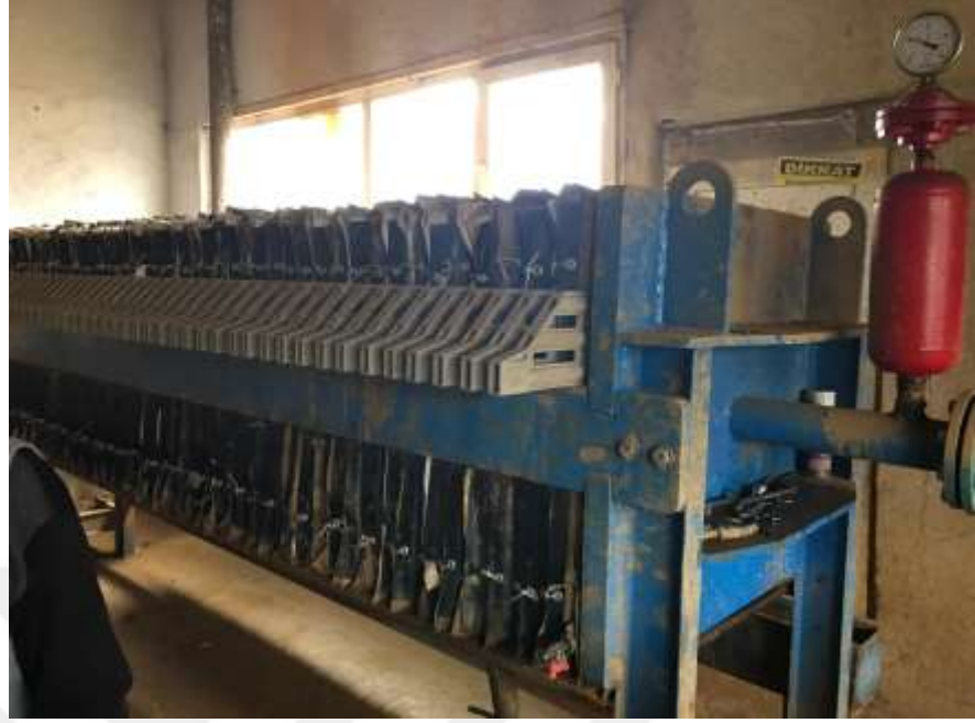
Fotoğraf 35 : Filter pres makinası. (Saadet MEKE 2018)
