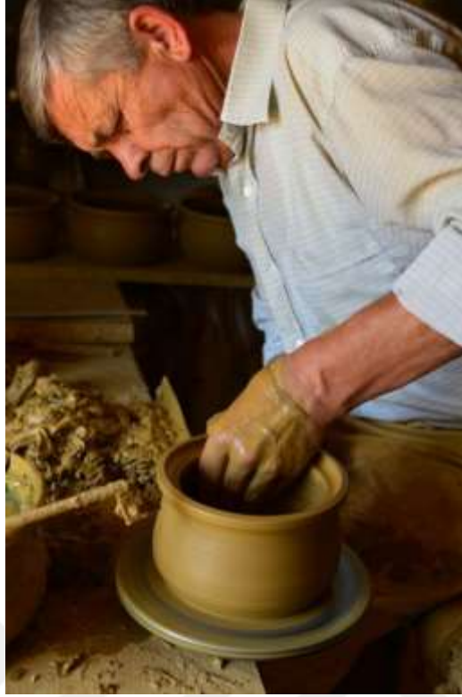
Fotoğraf 38 : Günümüzde torna tezgâhında çömleklerin şekillendirme aşaması. Nazmi Ceyhan –Çömlek Ustası (Saadet MEKE 2017)
