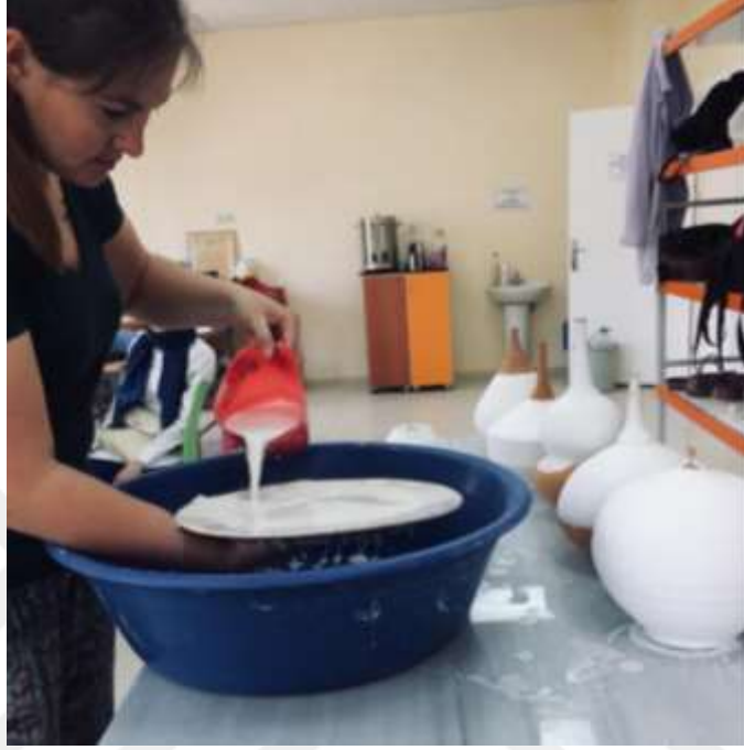
Fotoğraf 74: Akıtma yöntemi yapılarak ürünlerin sırlanması (Saadet MEKE 2019)
