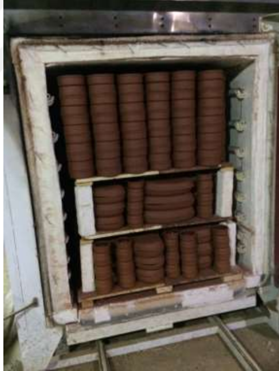
Fotoğraf 45 : Pres Kalıp ile Yapılan Sütlaçlık Güveçlerin Sır Fırınından Çıkışı.( Saadet MEKE 2017)
