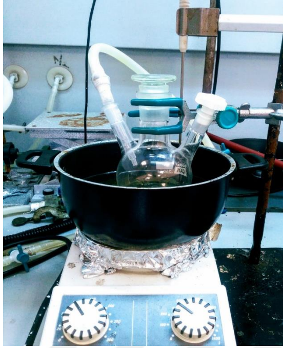
Şekil 3.1 : Tek adımlı PU sentezi için üç ağızlı reaksiyon balonu düzeneği.
