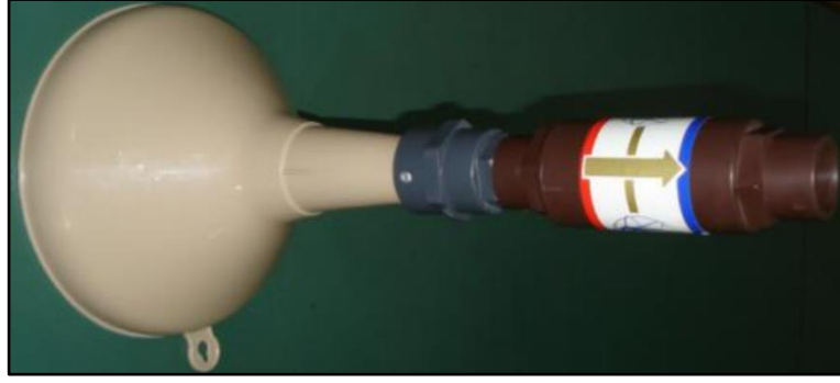
Şekil 2.2 Hozayn vd. (2015), çalışmasında kullanılan statik MA aleti (57-60 mT)
