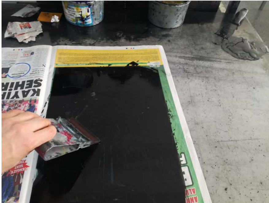
Şekil 5. Plakaya ragle yardımı ile boya verme işlemi
