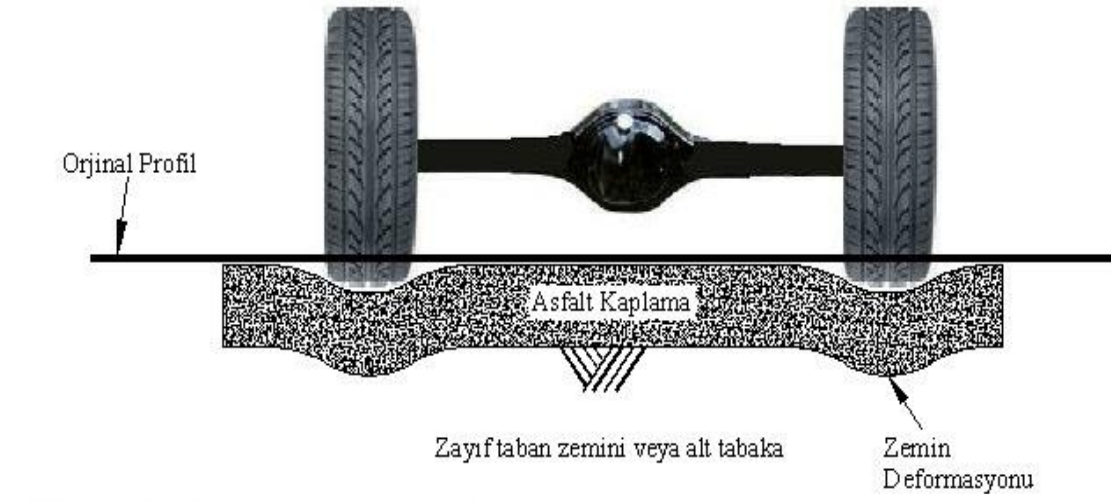
Şekil 2.13. Yapısal tekerlek izi oluşumu [25].
