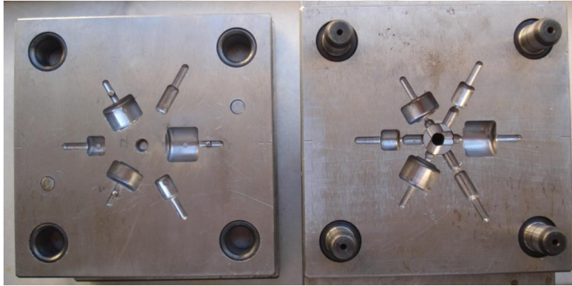
Resim 5.6. Numunelerin üretildiği toz enjeksiyon kalıbı
