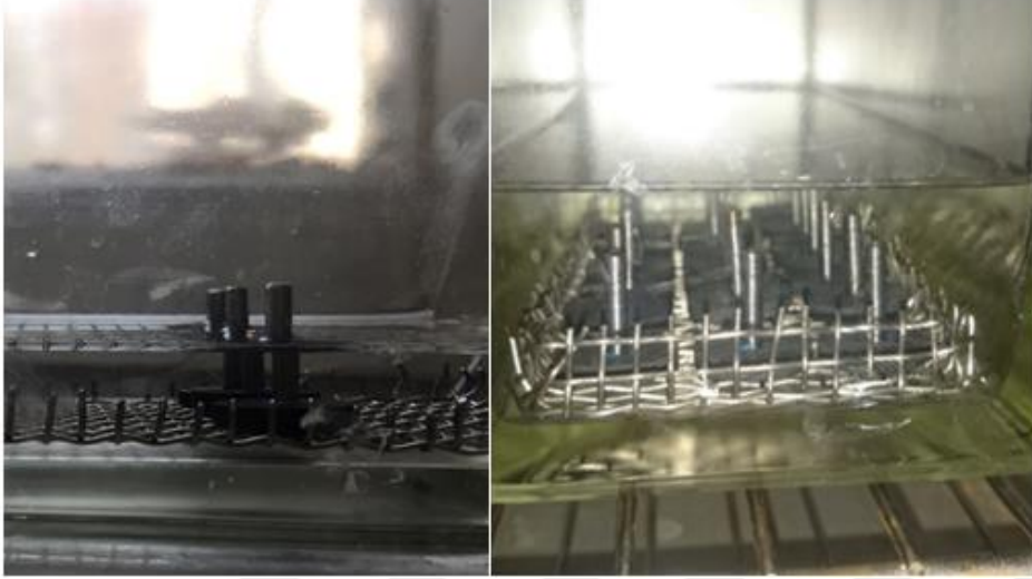
Resim 5.10. Kimyasal bağlayıcı giderme işlemine tabi tutulan numuneler
