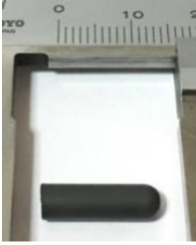
Resim 6.2. Dilatometre analizi için hazırlanan numuneler
