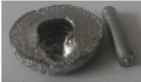
Resim 6.9. 1400 °C sıcaklıkta sinterlenmiş sıvı plastik arayüzeye sahip numune
