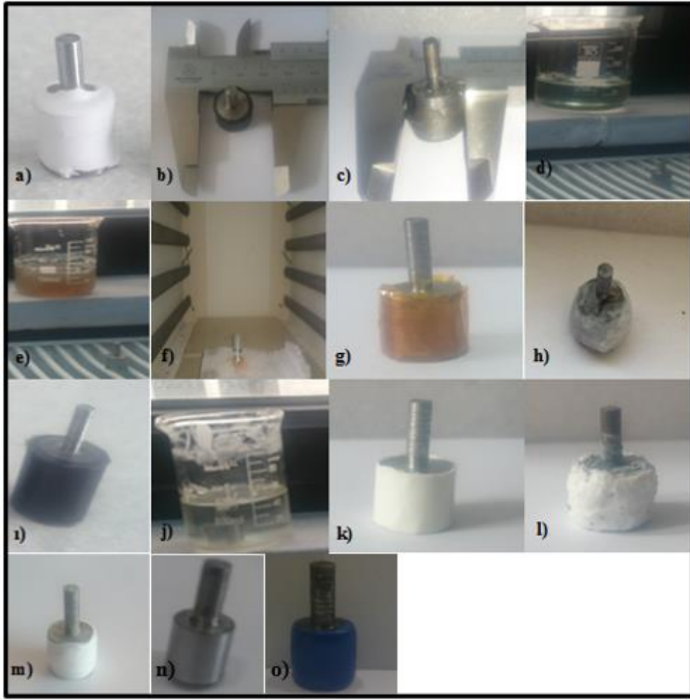
Resim 6.4. Olumlu ve olumsuz sonuç veren arayüzeyler; a) Boya, b) Poliolefin daralan makaron, c) Epoksi reçine, d) Etil selüloz çözeltisi, e) Nişasta çözeltisi, f) Parafin+Alümina tozu, g) Poliamid, h) Polietilen glikol çözeltisi, ı) Poliüretan, j) Polivinil alkol çözeltisi, k) Polivinil klorür, l) Polimetilsiloksan+silica+asetoksilan, m) Teflon bant n) Krom o) Sıvı plastik
