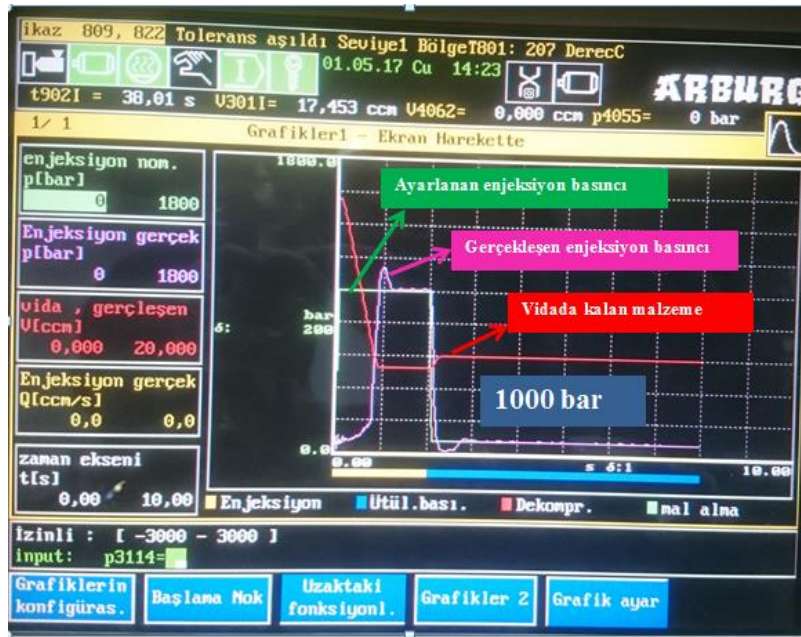
Resim 5.8. Arburg 220S enjeksiyon makinesi grafik ekran
