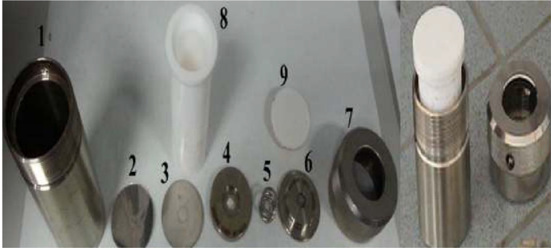
Şekil 2.3 Parr Asit Reaktörü Parçaları, 1) Dış koruyucu çelik kap, 2) Korozyon disk, 3) Patlama disk, 4) Alçak basınç disk, 5) Spiral yay, 6) Yüksek basınç disk, 7) Dış koruyucu çelik kapak, 8) Teflon kap (Reaksiyon kabı), 9) Teflon kabın kapağı.
