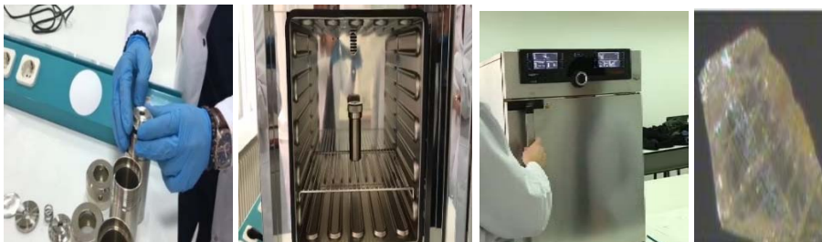
Şekil 3.3 Çözeltinin Fırına Yerleştirilmesi ve oluşan tek kristalin görünümü
