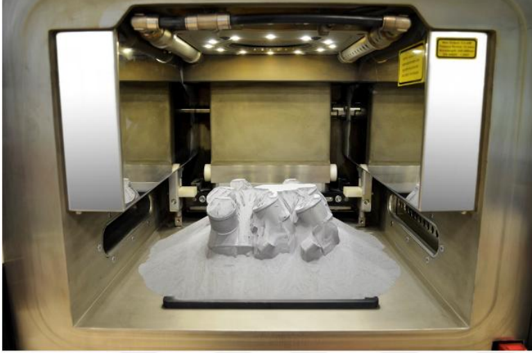
Resim 4.10. Mercedes katmanlı imalat teknolojisi ile yedek parça uygulaması [34]
