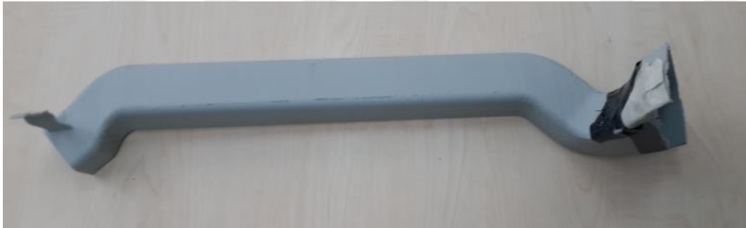
Resim 4.17. FDM ile baskısı yapılan ayak hava üfleç tasarımı
