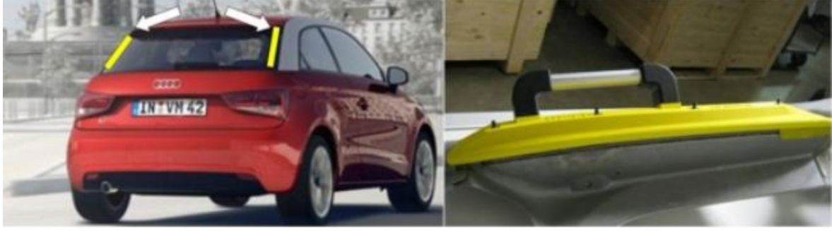
Resim 4.11. Audi katmanlı imalat teknolojisi ile imalat fikstürü uygulaması [35]
