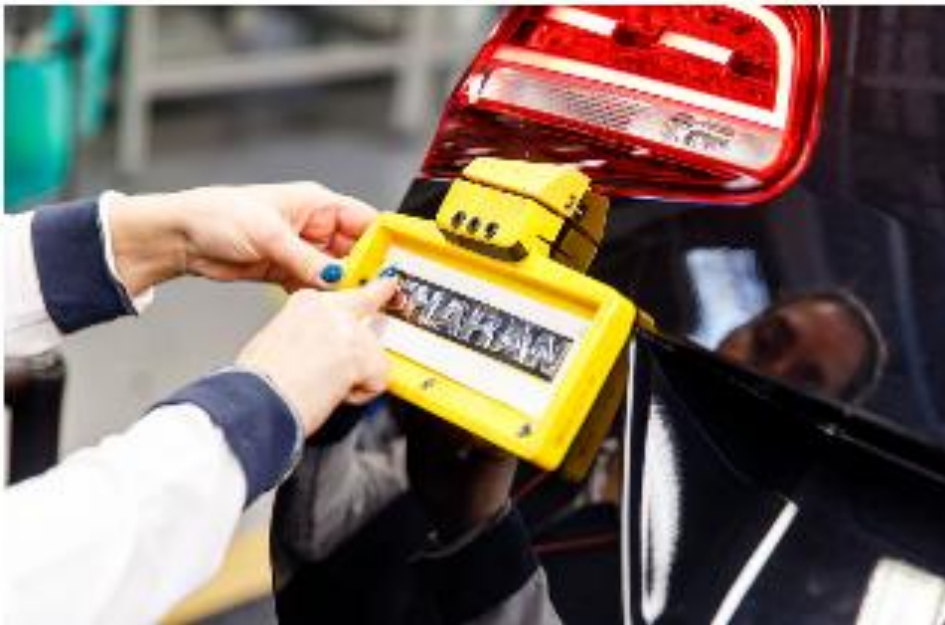
Resim 4.12. Volkswagen katmanlı imalat teknolojisi montaj fikstürü [36]
