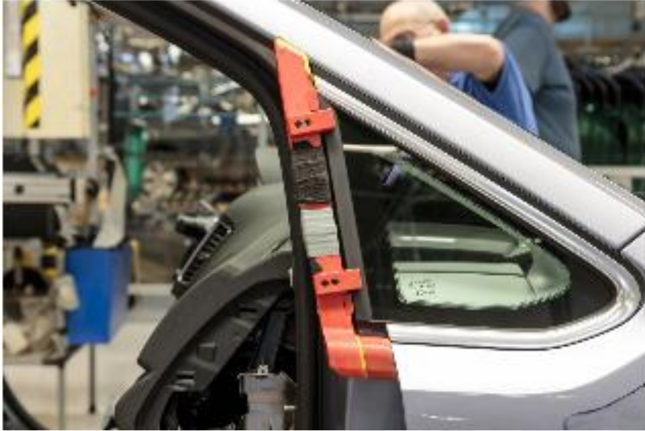
Resim 4.13. Volkswagen cam fikstürü [36]
