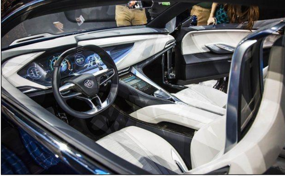
Resim 4.3. Buick Avista katmanlı imalat teknolojisi ile iç trim uygulaması [22]
