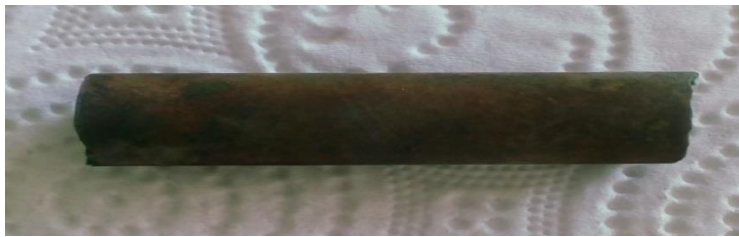
Resim 4.7. Osmotik akısız gerçekleştirilen kaplama işlemi sonrası destek
