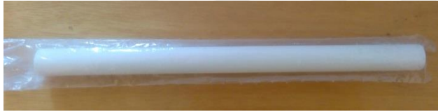
Resim 4.1. Destek malzemesi olarak kullanılan borosilikat cam tüp
