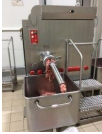
Şekil 5.3.Parça etlerin kıyma haline gelmesi.
