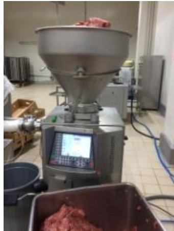
Şekil 5.5.Kıymaların baton dolum makinesinin kazanına eklenmesi.
