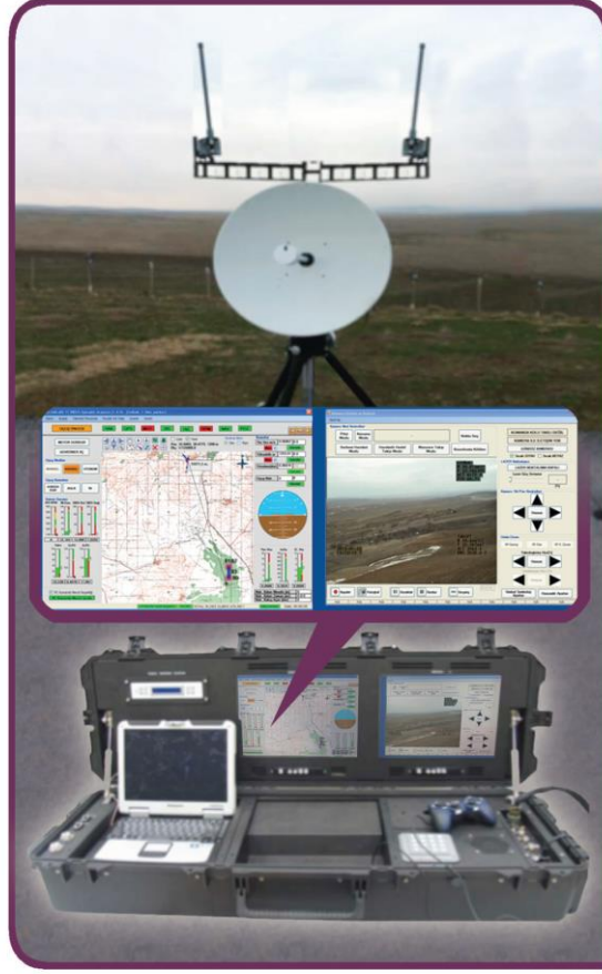
Şekil 3.21: ARI-1T yer veri kontrol istasyonu
