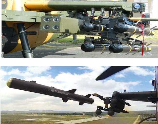
Şekil 5.1: MALE sınıfı İHA’larda kullanılan Akıllı tank savar mühimmatı UMTAS
