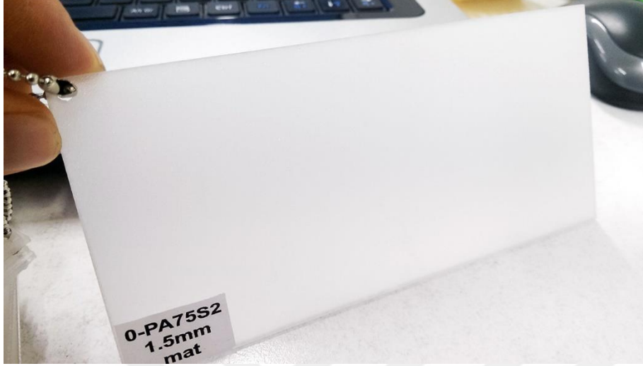
Resim 4.7. PA75S2 modeli difüzör plakası
