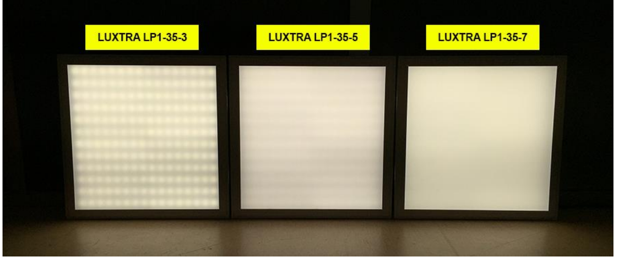
Resim 4.9. Kasa derinliğinin ışık kaynağının görünürlüğü üzerindeki etkisi
