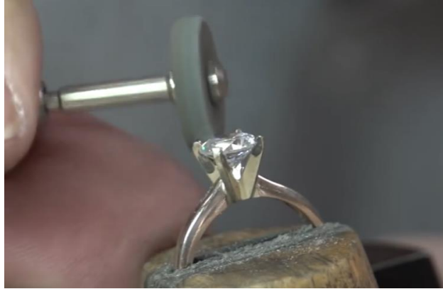
Şekil 121. Parlatma işlemi (Altuntaş, 2019).
