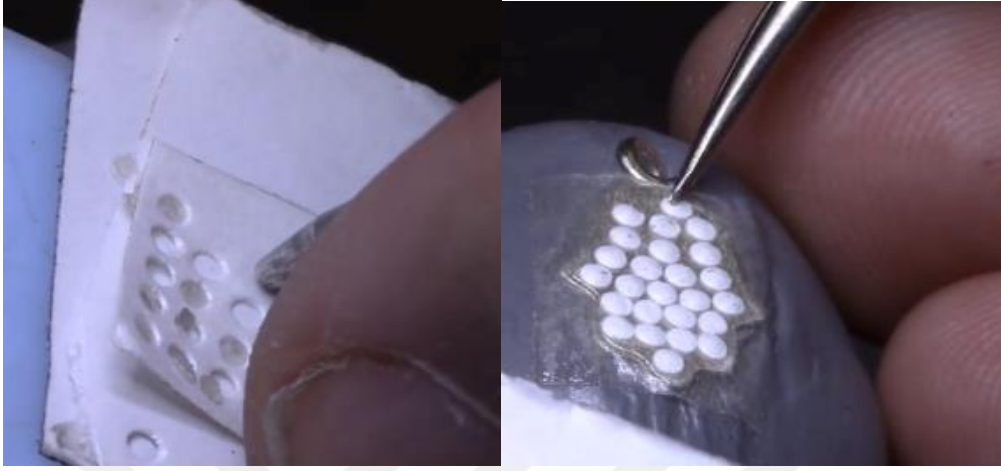
Şekil 100. Kâğıttan pul kesme işlemi (Altuntaş, 2019).
