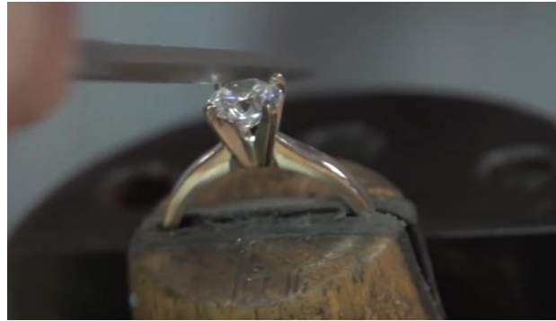
Şekil 119. Tırnakları tesviye işlemi (Altuntaş, 2019).
