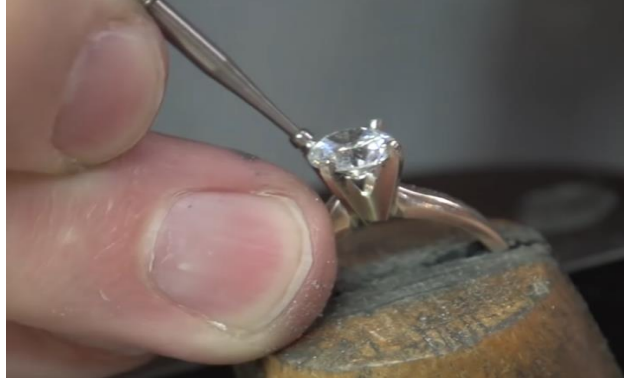
Şekil 120. Tırnaklarını yuvarlama işlemi (Altuntaş, 2019).
