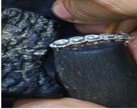
Şekil 82. Taşları yerleştirme işlemi (Altuntaş, 2019).
