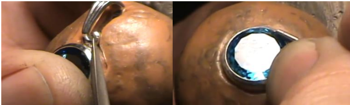
Şekil 112. Ege ile tesviye işlemi (Altuntaş, 2019).
