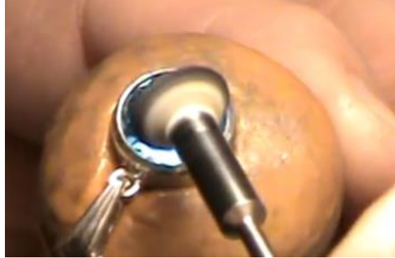
Şekil 114. Taş yuvasını freze ve lastik uçlarla parlatma işlemi (Altuntaş, 2019).
