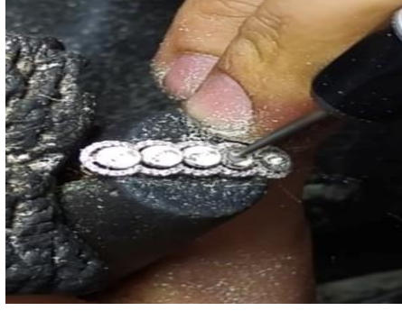
Şekil 81. Elmas yuvası açılma işlemi (Altuntaş, 2019).
