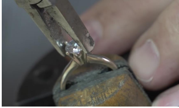
Şekil 118. Taş sıkıştırma işlemi (Altuntaş, 2019).
