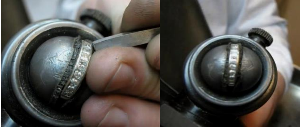
Şekil 97. Taşların sıvama işlemi (Altuntaş, 2019). Şekil 98. Mıhlanmış ürünün bitmiş hali
