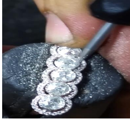
Şekil 84. Taş kenarının temizlenmesi (Altuntaş, 2019).
