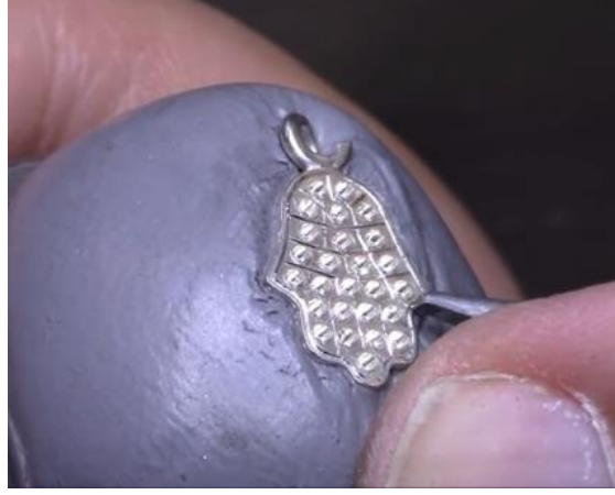
Şekil 103. Tırnak çıkarma işlemi (Altuntaş, 2019).
