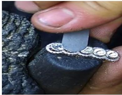
Şekil 83. Taşların seviye ayarının yapılması (Altuntaş, 2019).
