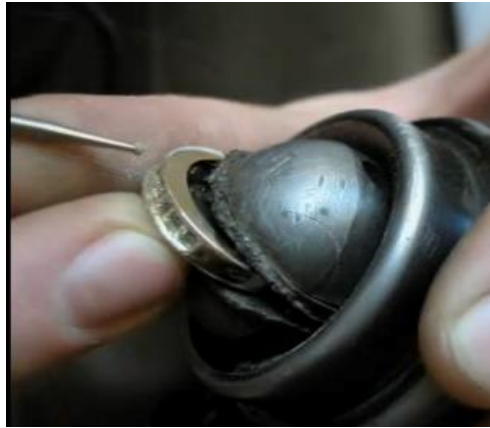
Şekil 94. Taş yuvası açma işlemi (Altuntaş, 2019).
