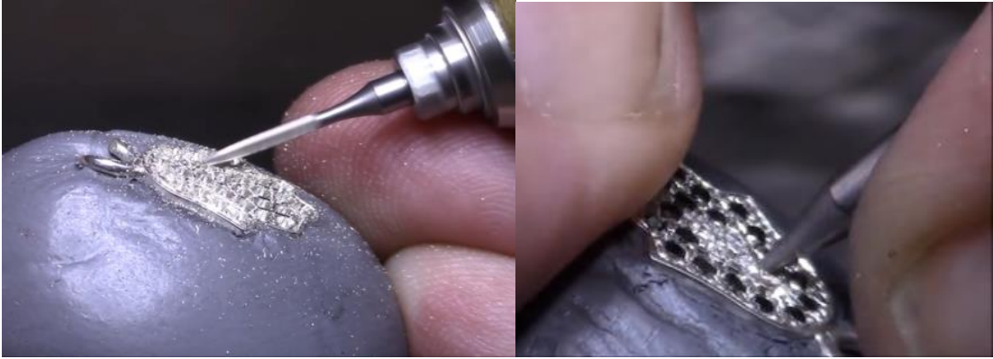
Şekil 104. Çapak temizleme işlemi (Altuntaş, 2019).
