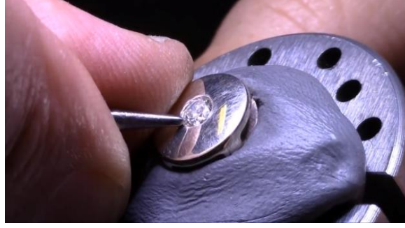
Şekil 91. Taşı mıhlama işlemi (Altuntaş, 2019).
