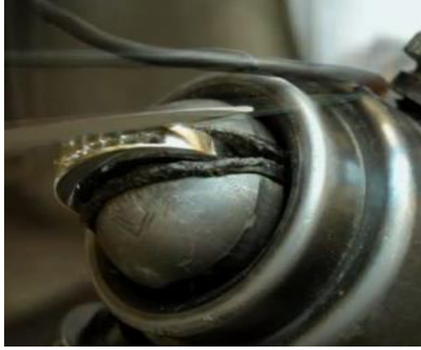
Şekil 95. Ege ile taş yuvası tesviye edilmesi (Altuntaş, 2019).
