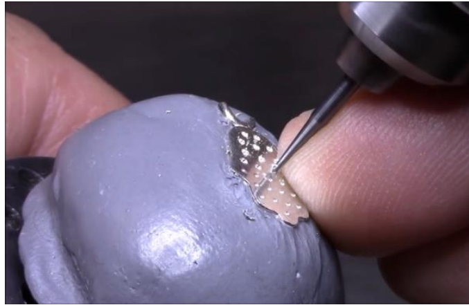
Şekil 102. Taş yuvası açılma işlemi (Altuntaş, 2019).
