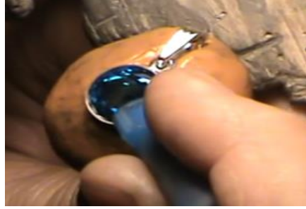
Şekil 109. Taşın seviye ayarının yapılması (Altuntaş, 2019).
