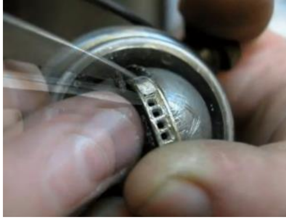
Şekil 96. Taş yerleştirme işlemi (Altuntaş, 2019).
