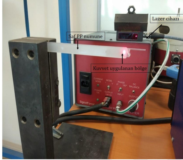
Şekil 4.6. Titreşim sönümlleme testi deney düzeneği
