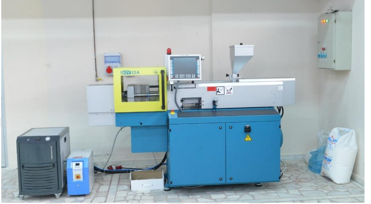
Şekil 4.3. Boy 22A model plastik enjeksiyon cihazı (Bartın Üniversitesi, 2019)
