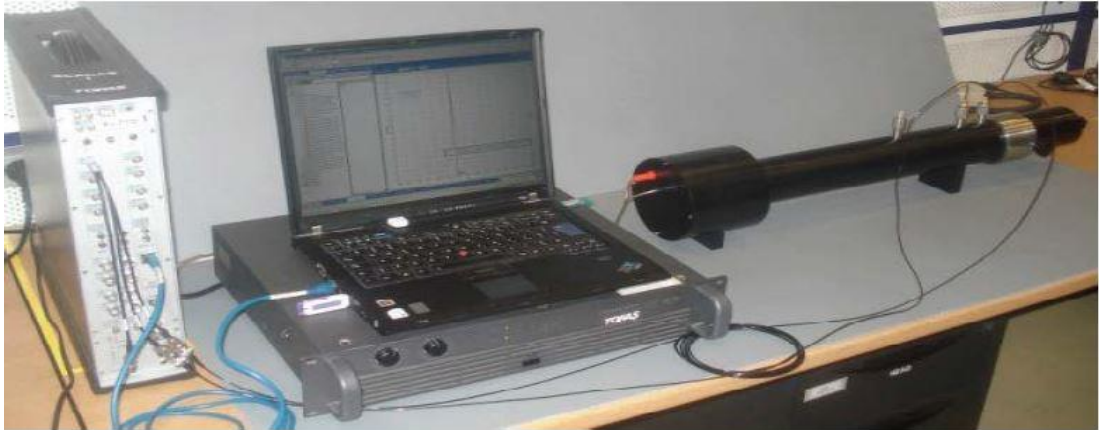
Şekil 4.11. Akustik performans testi deney düzeneği
