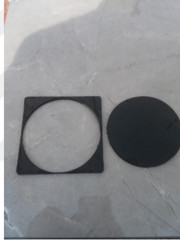
Şekil 4.5. Akustik performans testi için su jeti ile kesilmiş numune örneği
