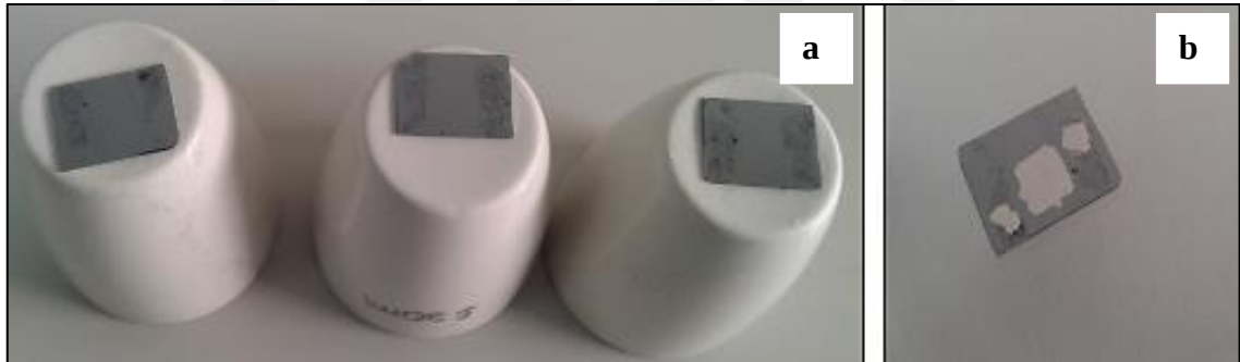
Şekil 24. Si/SiO 2 altlıkların p katkılanmış hali (a), Gümüş kontaklı p-n-p yapısı (b).
