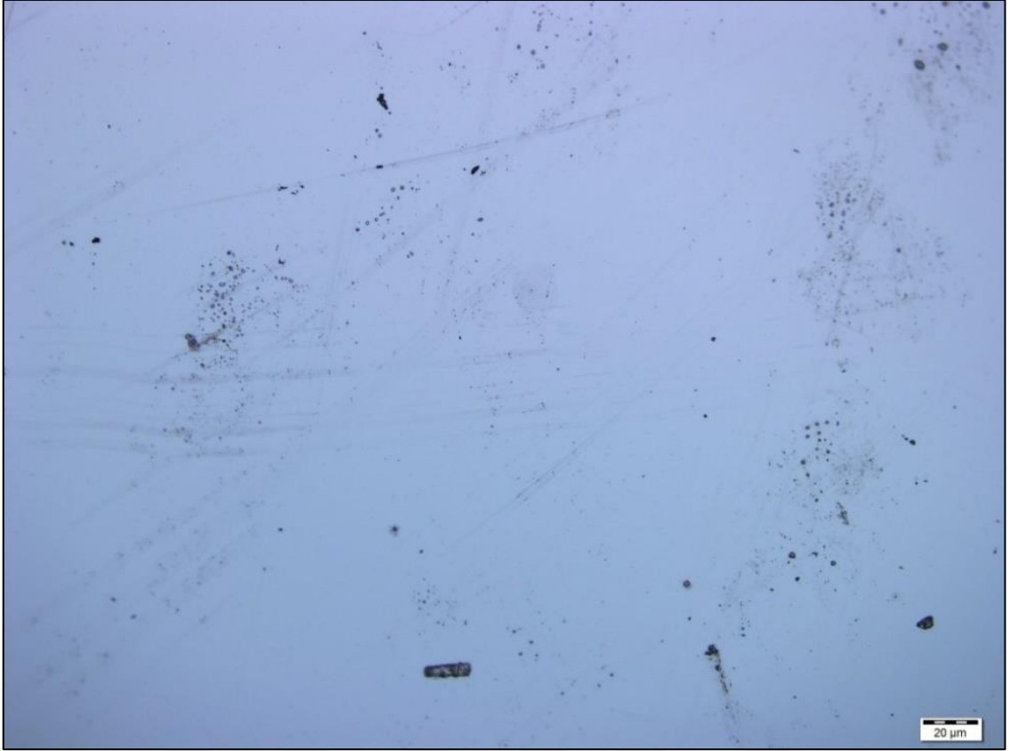
Şekil 22. n Si/SiO 2 altlık optik mikroskop görüntüsü.
