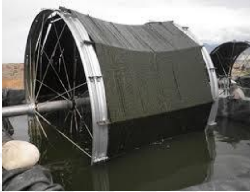
Şekil 2.4. Dönen algal biyofilm reaktör (Smith, vd., 2013).
