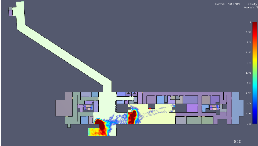
Şekil 4.21. Tahliye başladıktan sonra 80. saniyede bulunan kullanıcı sayısının platform üzerinde kullanıcı yoğunluğu dağılımı
