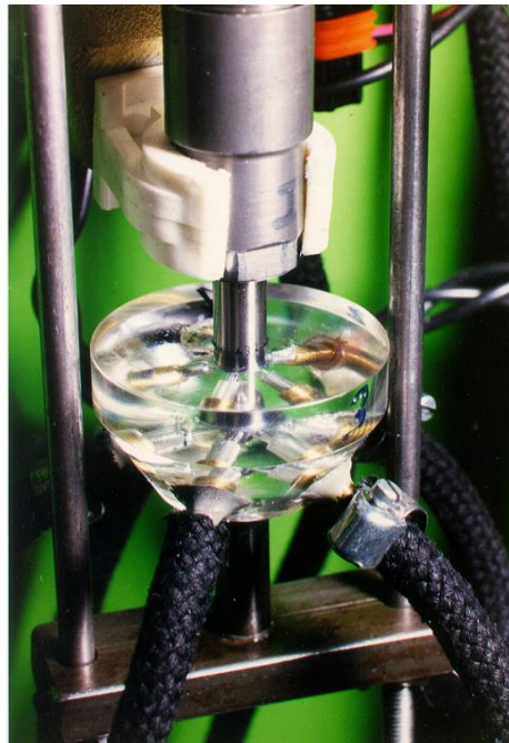
Bild 4. 6: Ansicht einer Einspritzdüse mit Mess - Adapter (Kunststoffvariante)
