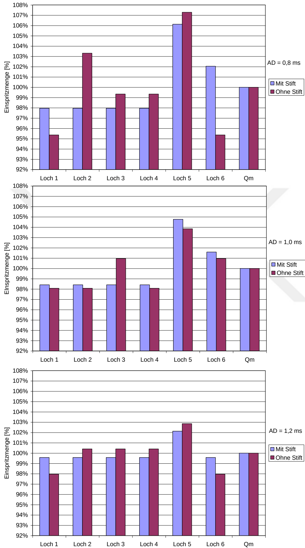
Bild 6. 23: Einflüsse der Fixierung der Druckstück Einzelstrahlmengen bei p_R = 400 \text{ bar} , Sitzlochdüse mit DNF
