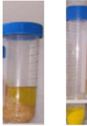
Şekil 3.7. Şeftalinin Quechers metodu ile ekstraksiyonu
