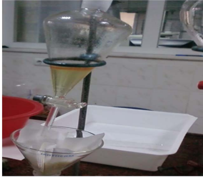
Şekil 3.6. Luke metodu ile pestisit ekstraksiyonu
