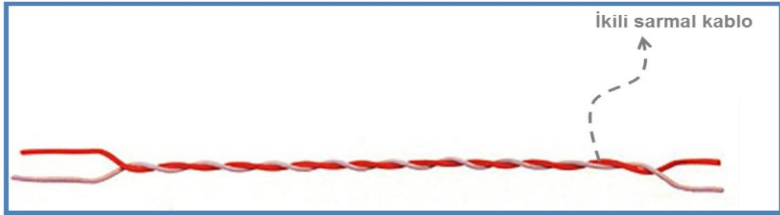
Şekil 2.10 CAN hattı sarmal kablo yapısı
