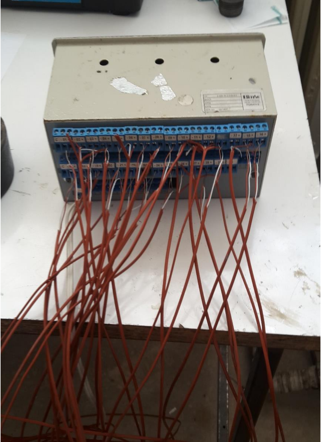
Şekil A8. Termokulpların kanal seçiciye bağlanması
