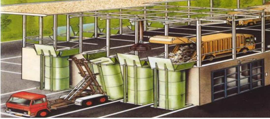
Şekil 1.6. Aktarma istasyonu ve çalışma şekli (Kırıl Mert, 2020)
