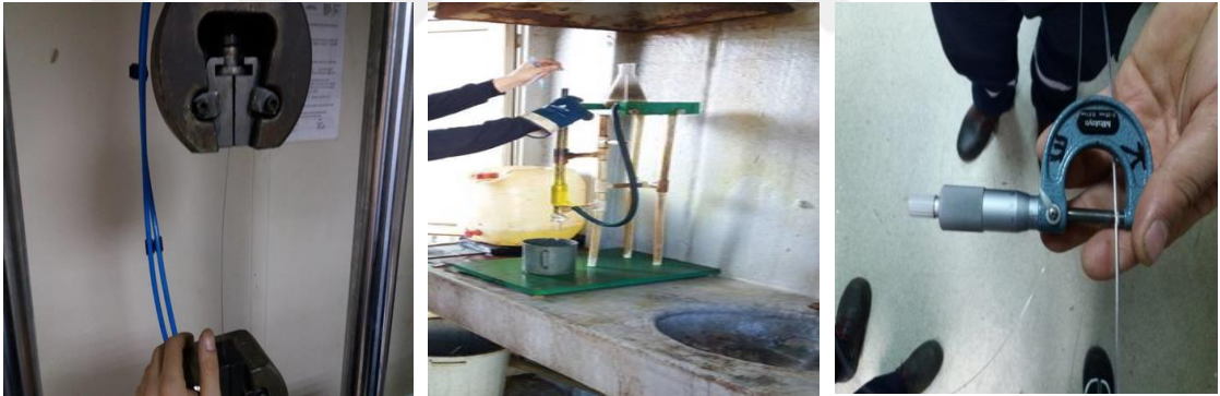
Şekil 5.13. Mukavemet, kaplama miktarı ve tel çapı ölçüm işlemleri
