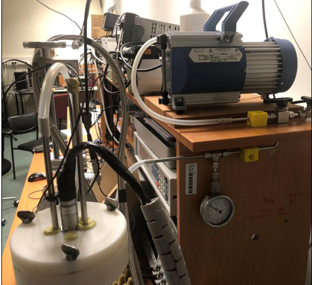
Şekil 3.25: Vakum pompası ve bağlantıları.
