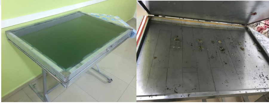
Şekil 4.2. Deneyde kullanılan kollektörün açık ve kapalı hali
