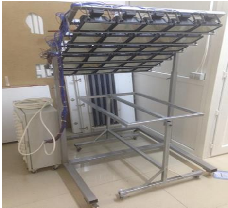
Şekil 4.4. Deneyde kullanılan güneş simülatörü ve kontrol paneli
