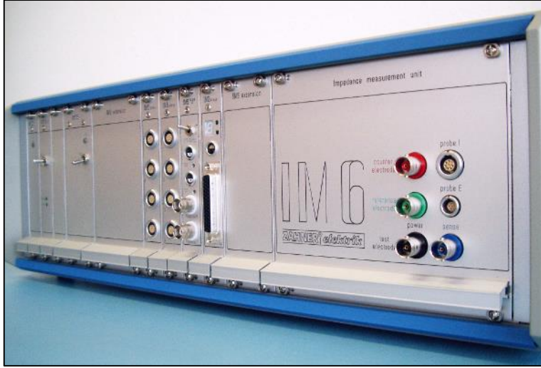
Şekil 4.4 Empedans ölçümlerinde kullanılan Zahner Im6 model potansiyotat
