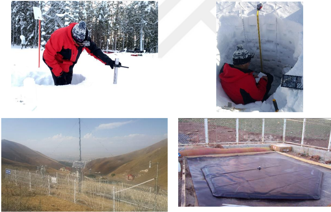
Şekil 2.4. Yerinde yapılan kar ölçüm örnekleri. Üst sırada bulunanlar münferit, alt sırada bulunanlar ise otomatik ölçüm örnekleridir.
