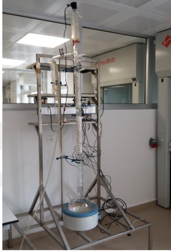
Şekil 4.1 Tepkimeli dolgulu damıtma kolonlu deney sistemi
