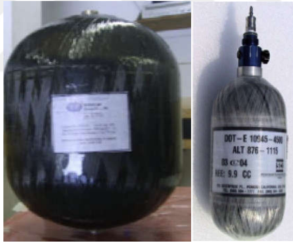
Şekil 4.1 Spider Lion ve Ion Tiger programları için geliştirilen özel tanklar [76]
