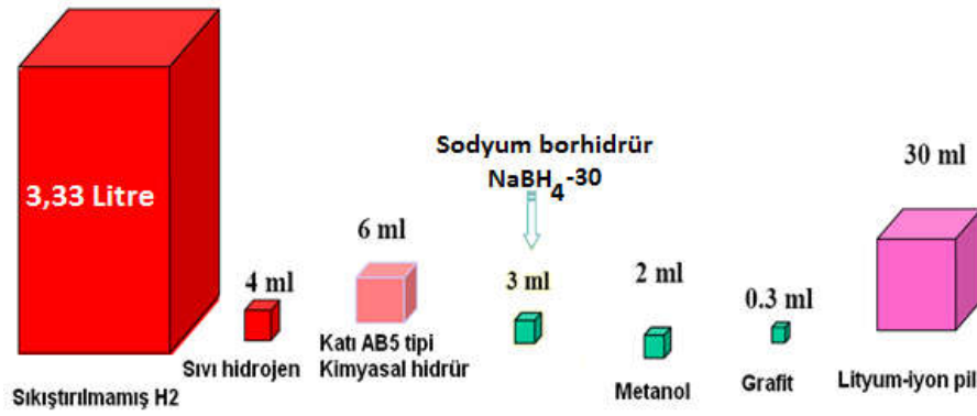
Şekil 4.4 Eşdeğer enerji kapasitesine sahip çeşitli kaynakların hacim değerleri [124]
