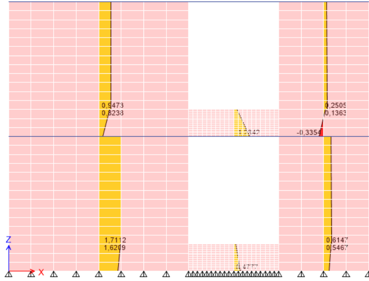
Şekil 3.4.3: EX kuvveti altında (1) 1 aksı duvarlarında oluşan kesme kuvveti diyagramı, (2) 2 aksı duvarlarında oluşan kesme kuvveti diyagramı.
