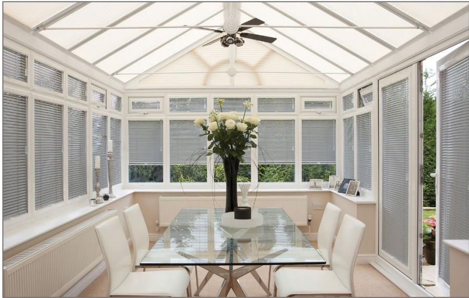
Şekil 3.52: Jaluzi perde sistemi örneği
