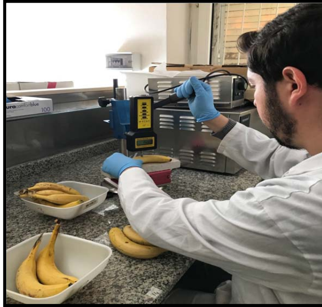
Şekil 3.6. Dwarf Cavendish Muz Meyvesinin Kabuk Sertliği Ölçümü.
