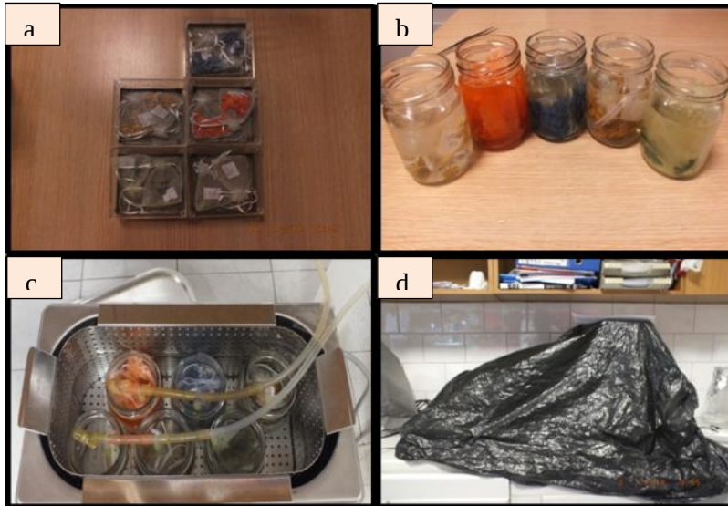
Şekil 3.2 Oransal nem artımı (a), tohumların kavanozlara yerleştirilmesi (b), US uygulamasının yapılması (c, d)
