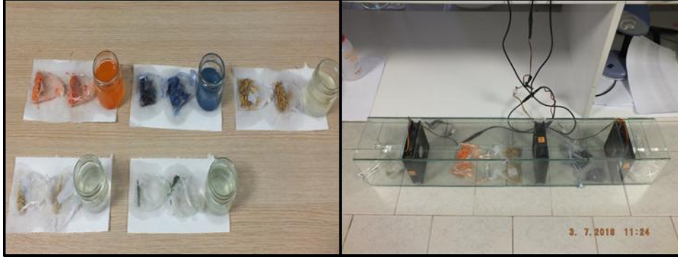
Şekil 3.3 Tohumların kavanozdan çıkarılması ve başlangıç ağırlığına kadar kurutulması
