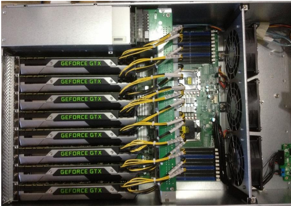
Resim 2.5: Bir Anakart Donanımı Üzerine Takılan Sekiz GPU İle Oluşturulmuş Render Farm Görüntüsü
