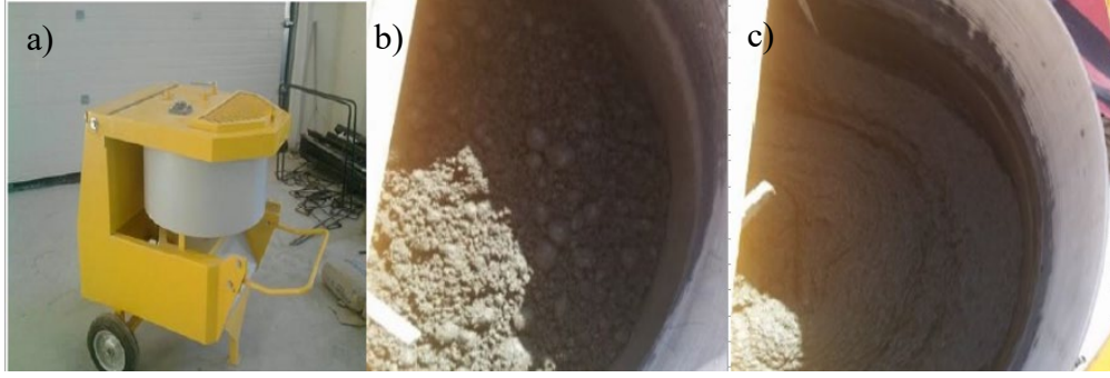
Şekil 2.2: UYPB karışımının hazırlanması, a) Kullanılan pan-mixer, b) Yarı kuru karışım, c) Plastik kıvamlı karışım.
