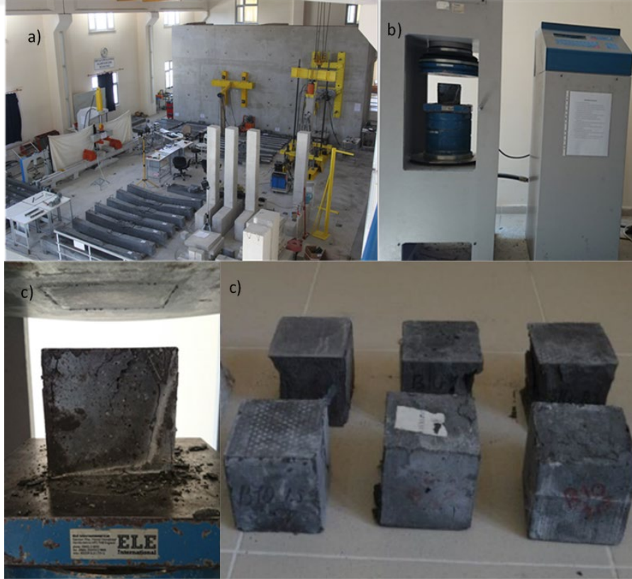
Şekil 2.6: a) Yapı mekaniği laboratuvarı b) Basınç presi c) Kırılmış küp numuneler.
