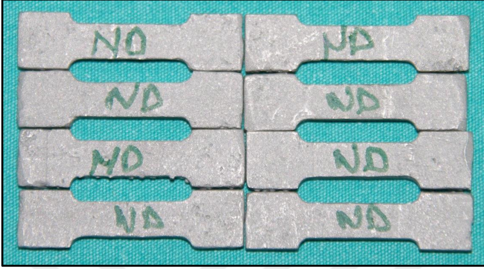
Şekil 3-1: Konvansiyonel döküm işlemi ile hazırlanan deney örnekleri
