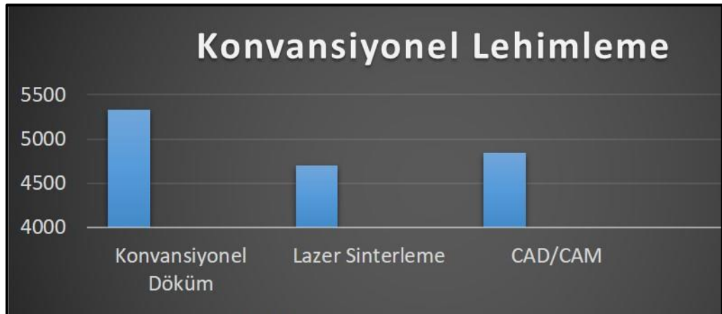
Şekil 4-5: Konvansiyonel lehimleme grubunda üretim yöntemlerine göre gerilme dayanımları
