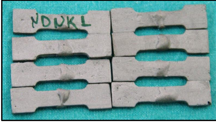
Şekil 3-7: Konvansiyonel lehim ile lehimlenen altyapılar
