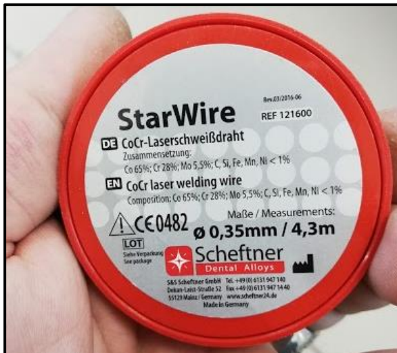
Şekil 3-9: Lazer lehimlemede kullanılan metal alaşım
