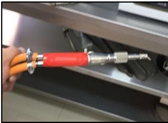
Şekil 3-6: Konvansiyonel lehimleme için kullanılan şalöme
