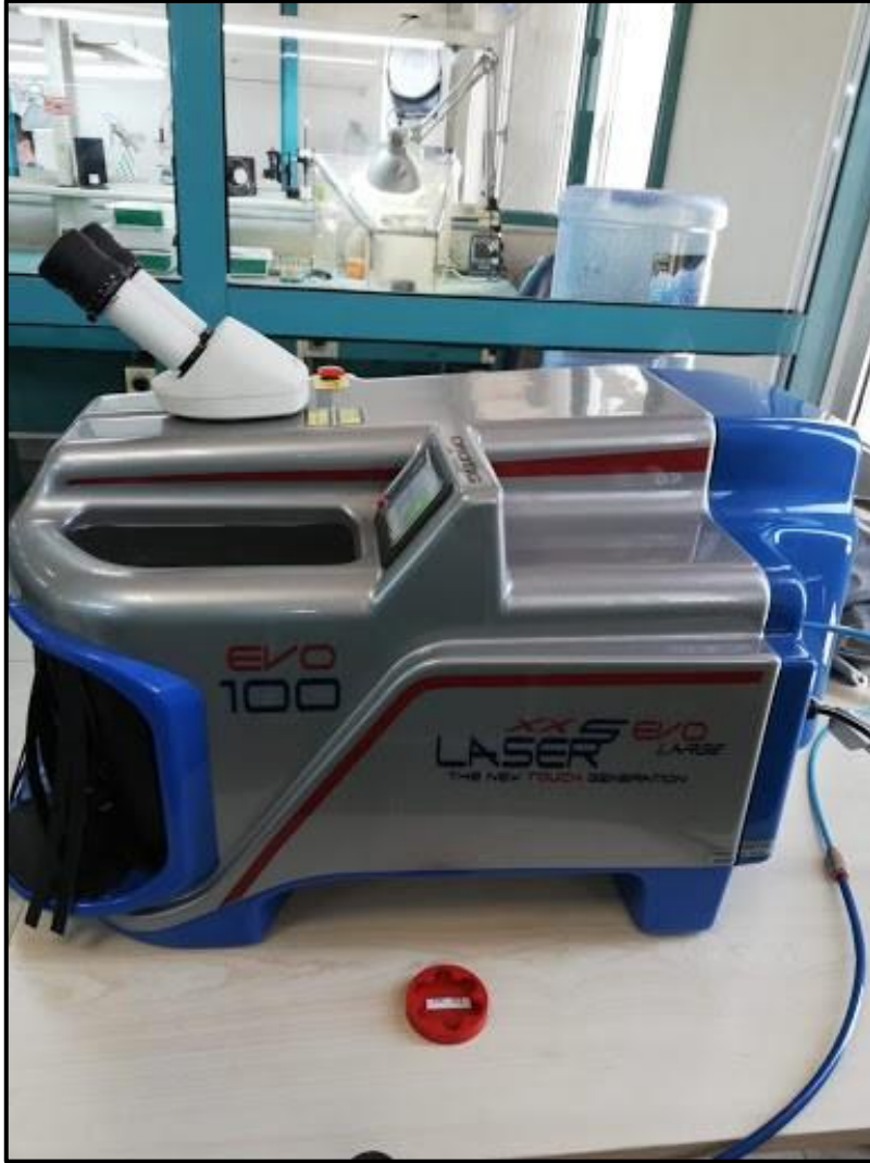
Şekil 3-8: Lazer lehimlemede kullanılan lazer cihazı
