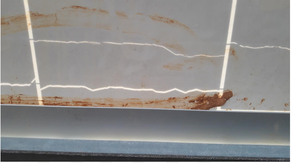
Şekil 4.35. Kılcal Çatlak olan PV Panel (Alttan Görünüm)
