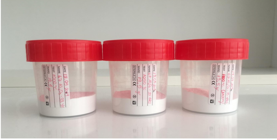
Şekil 8. Ağırlıkça %33 Y_2O_3 ve %67 Al_2O_3 tozlarının karıştırılıp ayrılmış hali
