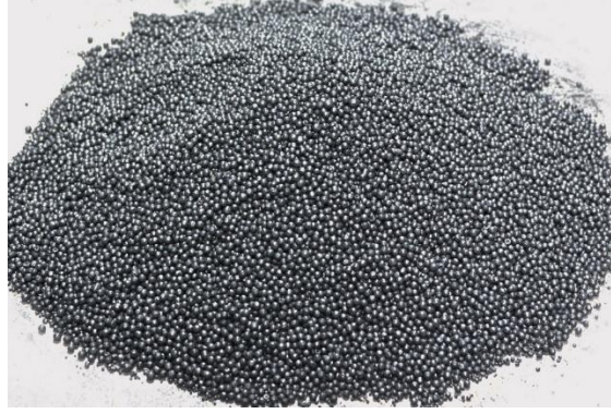
Şekil 3.14. Çelik granülle kumlama [17].
