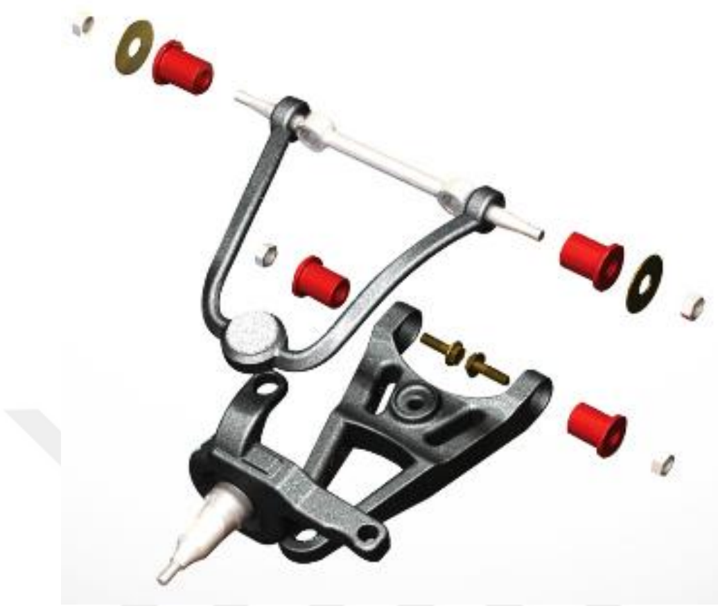
Şekil 3.2. Salıncak üzerinde kauçuk metal burç gösterimi.
