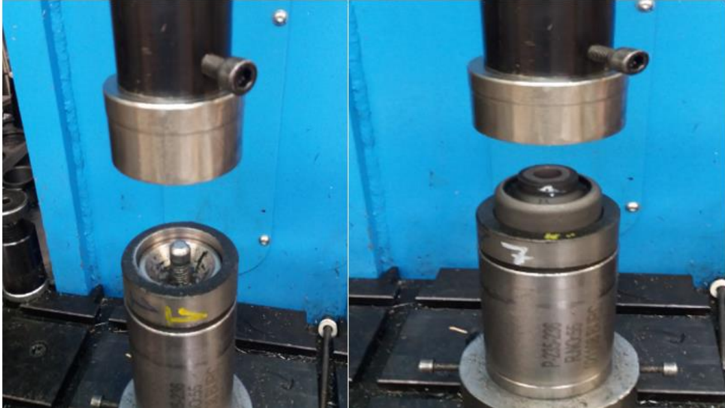
Şekil 4.9. Burcun salıncağa çakılması gösterimi.
