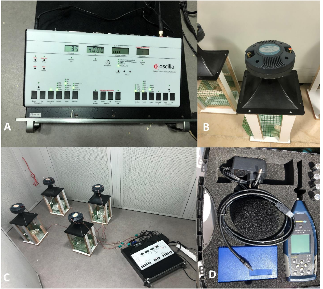
Şekil 29: A: Odyometri cihazı B: Tweeter C: Gürültü düzeneği D: Ses ölçümü için desibelmetre cihazı.
