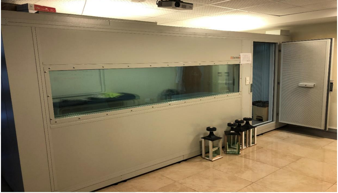
Şekil 27: ABR ve DPOAE ölçümlerinin yapıldığı odyolojik sessiz kabin
