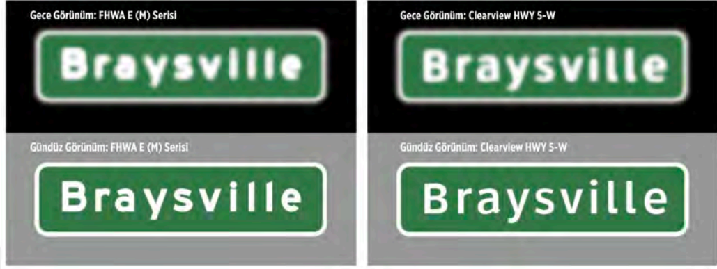
Şekil 6.22. FHWA E(M) ve Clearview yazı fontunun gece-gündüz karşılaştırılması.
