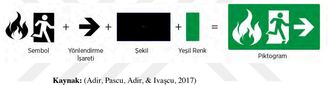
Şekil 6.29. Piktogram oluşturmak için birkaç öğenin birleştirilme denklemi.
