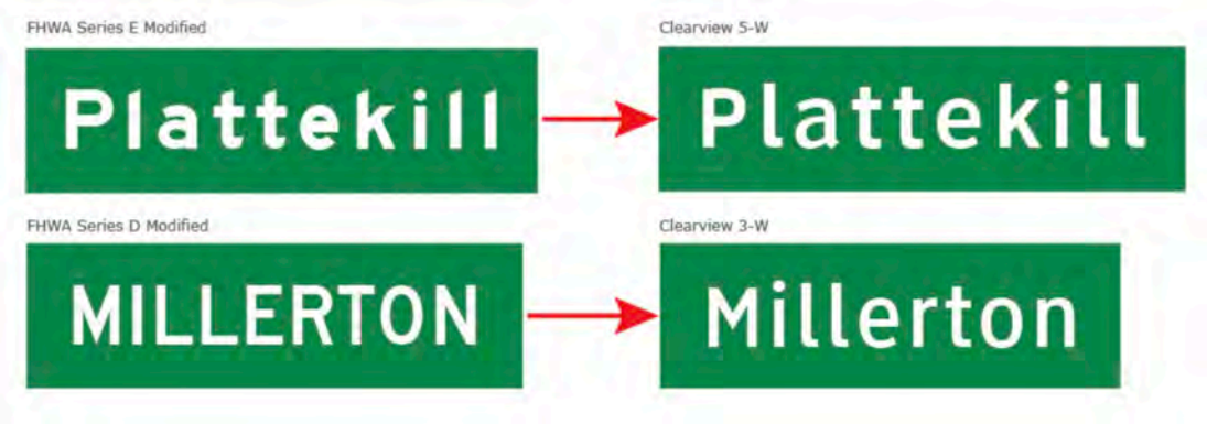
Şekil 6.23. FHWA E(M) ve Clearview 5-W yazı fontların büyük ve küçük harf karşılaştırılması.
