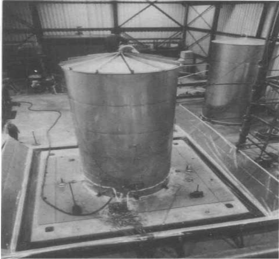
Şekil 2.13. Sarsma levhası üzerinde 1 numaralı tank (NIWA ve CLOUGH 1982)
