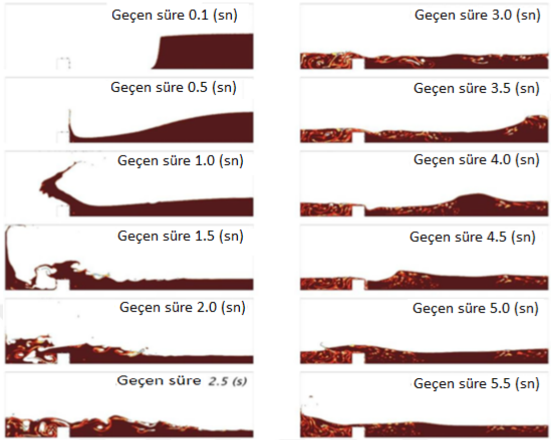
Şekil 2.8. Baraj kırılma akışı simülasyonundan 0.5 saniye aralıklarla alınmış olan görüntüler (Jeltsov vd. 2018)
