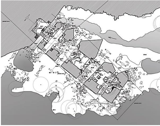
Şekil 152. Batı Değirmeni Bodrum Kat Rölövesi
