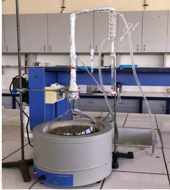
řekil 3.2.Defne uęucu yaę tayini yapılan clevenger cihazı
