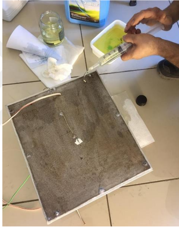
Şekil 6.6. İç ortam deneylerinde kullanılan FV panelin hazırlanması
