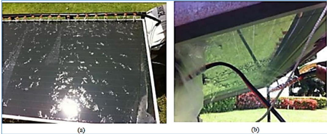
Şekil 5.8. Alt/üst yüzeyden su püskürtmeli soğutma (Phayom, 2014)
